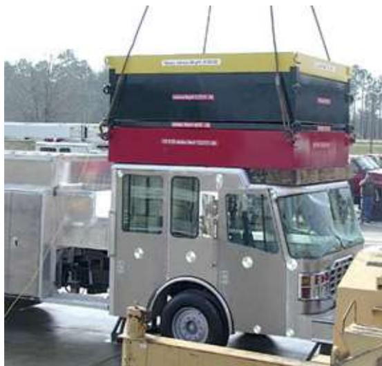
**Figura 17 Prueba de carga sobre el techo a un camión de bomberos**
