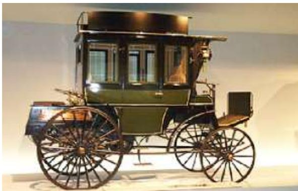
**Figura 2 Primer autobus con motor de combustión**
