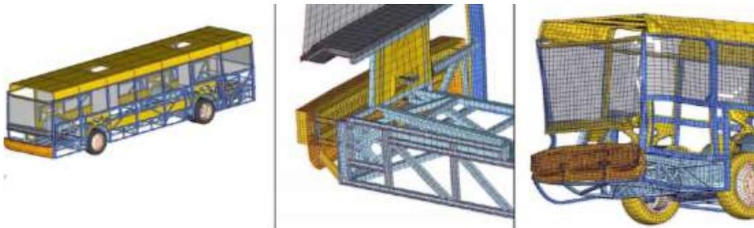
**Figura 16 Simulación de un bus sometido a impacto frontal**
