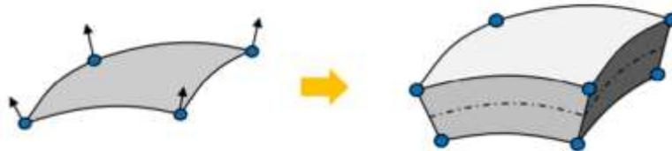
**Figura 29 Asignando espesor a superficie intermedia**
