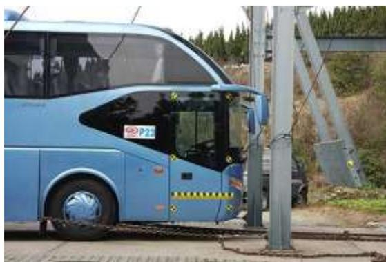
**Figura 19 Prueba de impacto frontal a un bus de construcción China**
