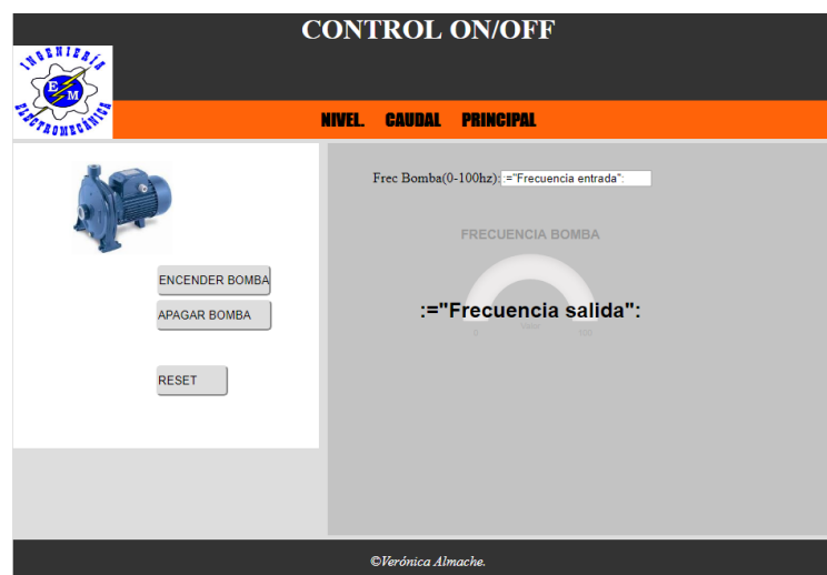
Figura 61: Página web creada para controlar variables del PLC.
