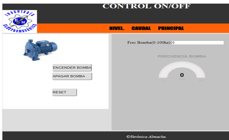
Figura 73: Pagina WEB de control ON/OFF de la bomba hidráulica.
