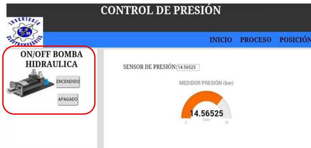
Figura 30: Visualización en el navegador de la variable encendido bomba hidráulica.
