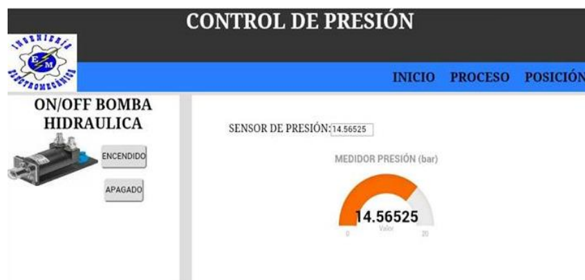
Figura 86: Accionamiento bomba hidráulica y control de presión.
