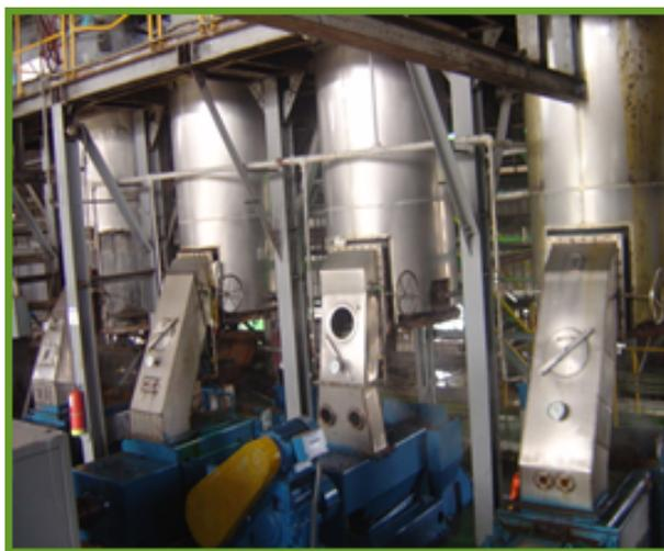
Figura 13: Digestor de palma conectado a la prensa en la continuación del proceso de extracción.
