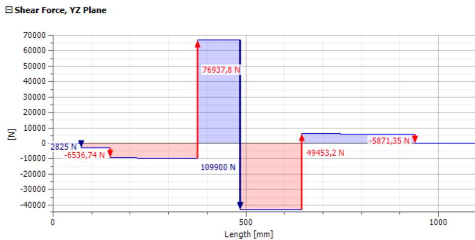
Figura 48: Diagrama de cortantes del eje en el plano YZ.
