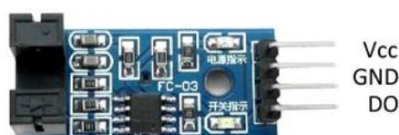
**Figura 109. Pines del sensor FC-03**
