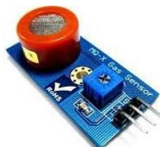
**Figura 8. Sensor MQ-3 para detección de alcohol y benceno**
