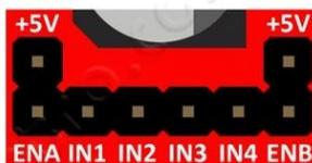
**Figura 118. Pines para el control de sentido de giro**
