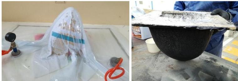
**Figura 57 Fin del proceso de curado y remoción del molde.**
