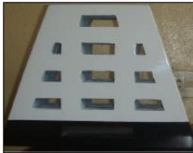
**Figura 5 Atenuador de impacto de balsa prototipo 1.**
