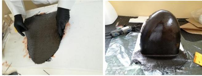
**Figura 54 Impregnado con resina y recubrimiento del molde**
