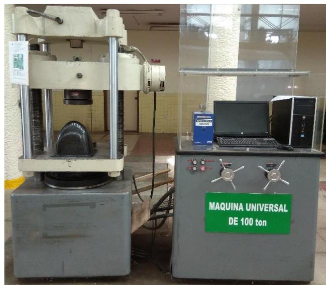
Figura 60 Máquina universal de ensayos Tinius Olsen 1000 kN.
