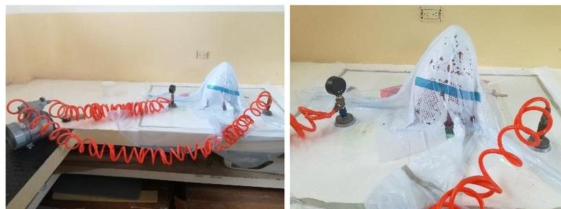
**Figura 56 Proceso de curado en bolsa de vacío.**
