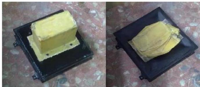
**Figura 16 Atenuador de impacto antes del experimento, después del experimento.**
