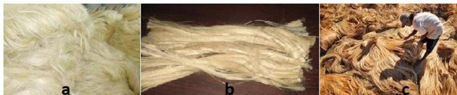
**Figura 27 De izquierda a derecha; Fibra de Sisal, Kenaf y Abaca.**
