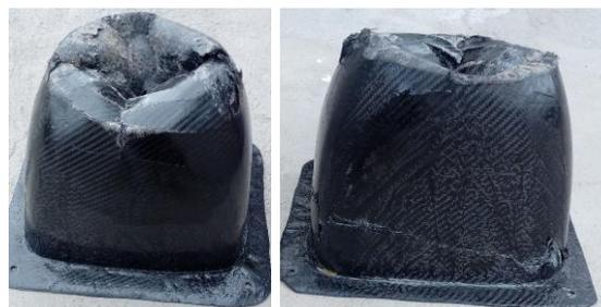
**Figura 67 Deformación y Daño Test Cuasi Estático.**
