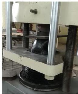
Figura 61 Test de Aplastamiento Cuasi Estático 350 segundos.
