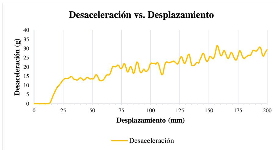
**Figura 46 Desaceleración vs. Desplazamiento Fibra de Carbono.**
