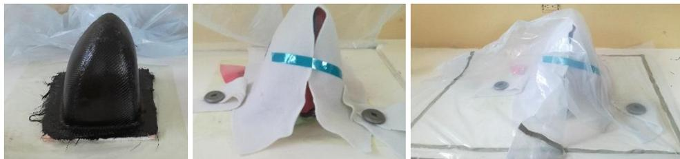
**Figura 55 Molde recubierto de fibra, Ubicación de acoples, Sellado hermético**
