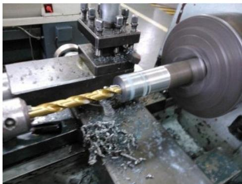
**Figura 80 Construcción del bocín**
