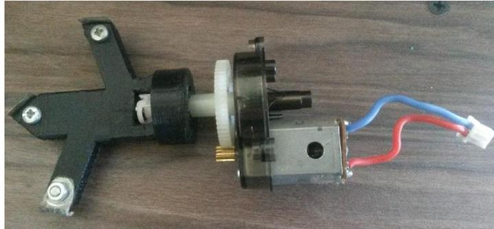
**Figura 58 Detalle del Conjunto Motor - Reducción Motores Syma X8C**
