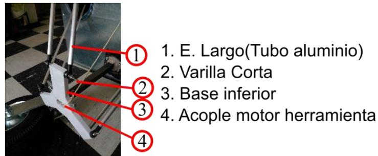
**Figura 92 Detalle subensamblaje Eslabón Largo - Base inferior**
