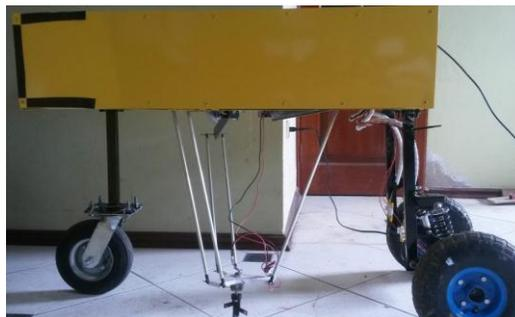
**Figura 95 Robot Delta ensamblado en la plataforma**
