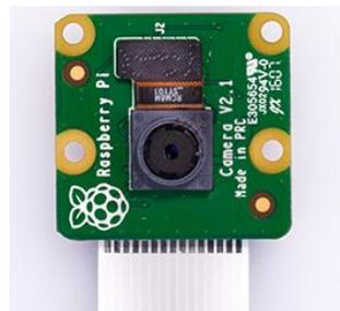
**Figura 99 Detalle del Módulo de Cámara V2 para Raspberry Pi**
