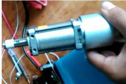
**Figura 79 Ensamblaje del conjunto motor-caja reductora**
