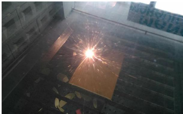
**Figura 81 Proceso de corte láser en baquelita**
