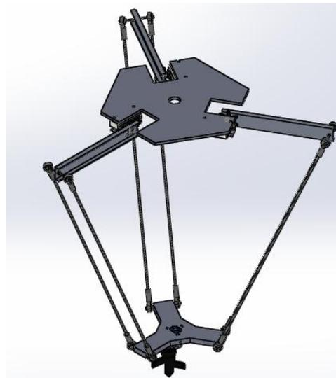
**Figura 62 Ensamble del robot tipo Delta**
