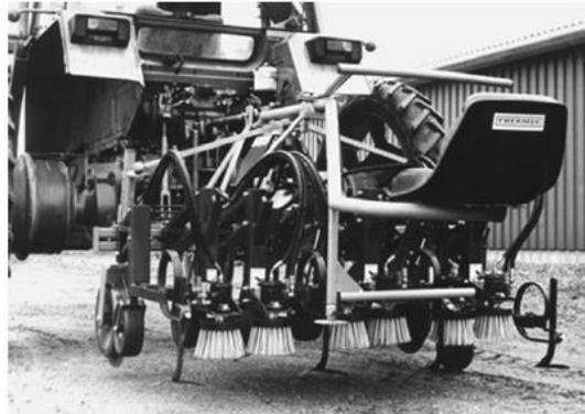
**Figura 11 Herramienta rotatoria de deshierbo por cepillos**
