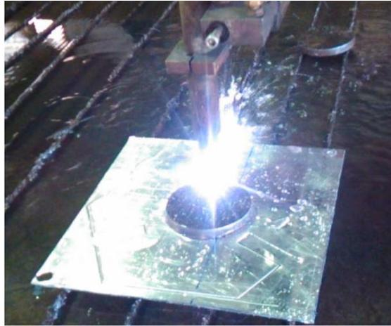
Figura 88 Proceso de corte por plasma sobre aluminio
