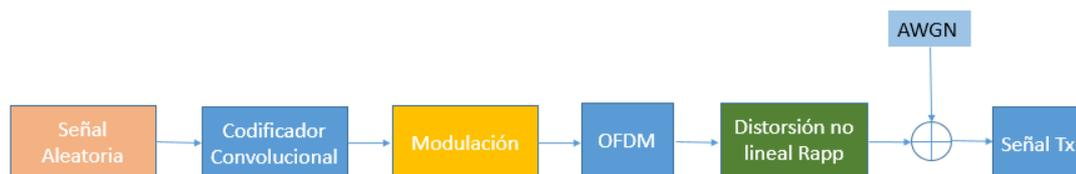
Figura 11. Diagrama de bloques de la señal transmitida
