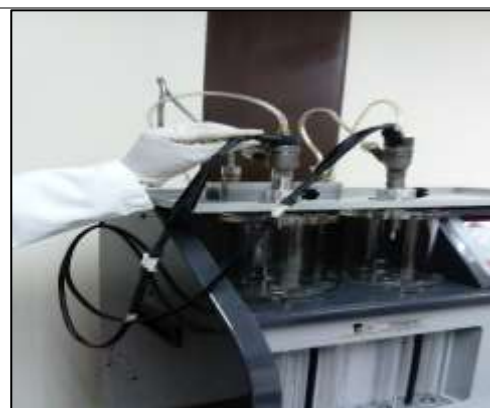
Figura 50 Conexión de sockets
