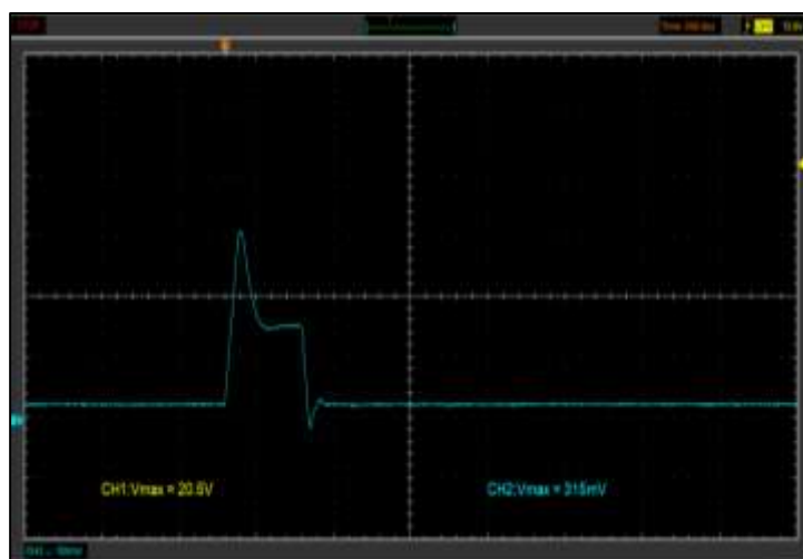
Figura 110 Oscilograma de corriente, tiempo de inyección 0.25ms del inyector CRDI Bosch 0445110126.
