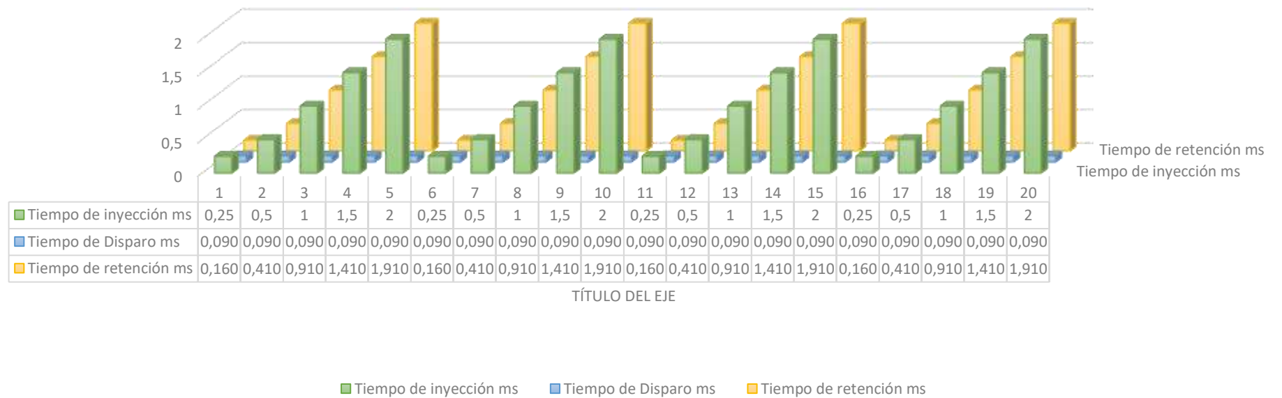
Figura 93 Interpretación gráfica del inyector Bosch 0445110126 a una presión de 400 bar con variación de números de pulsos en (250, 500, 750, 990) STRK y con tiempos de inyección de (0.25, 0.5, 1, 1.5, 2) ms, calculando el tiempo de disparo y el tiempo de retención.
