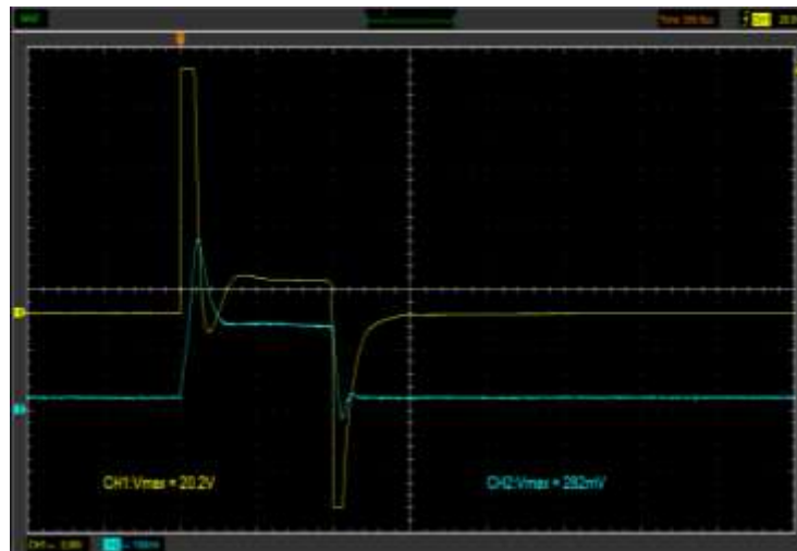
Figura 162 Oscilograma de corriente y voltaje, tiempo de inyección 1 ms del inyector CRDI Bosch 0445110293.
