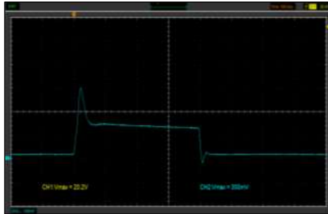
Figura 167 Oscilograma de corriente, tiempo de inyección 2 ms del inyector CRDI Bosch 0445110293.
