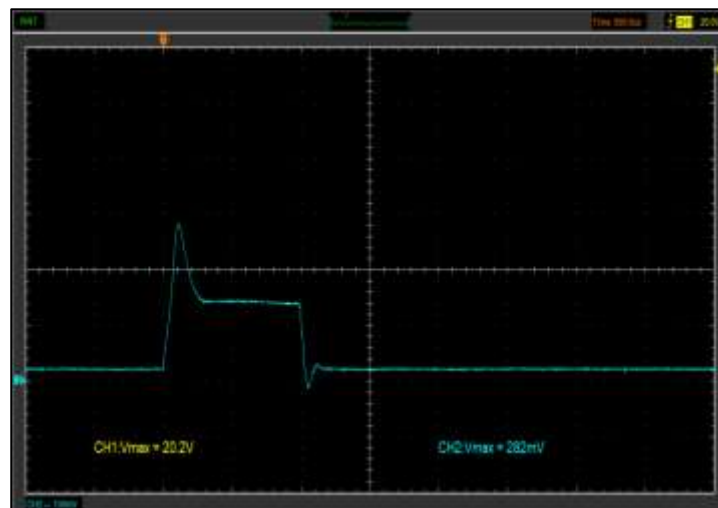
Figura 161 Oscilograma de corriente, tiempo de inyección 1 ms del inyector CRDI Bosch 0445110293.
