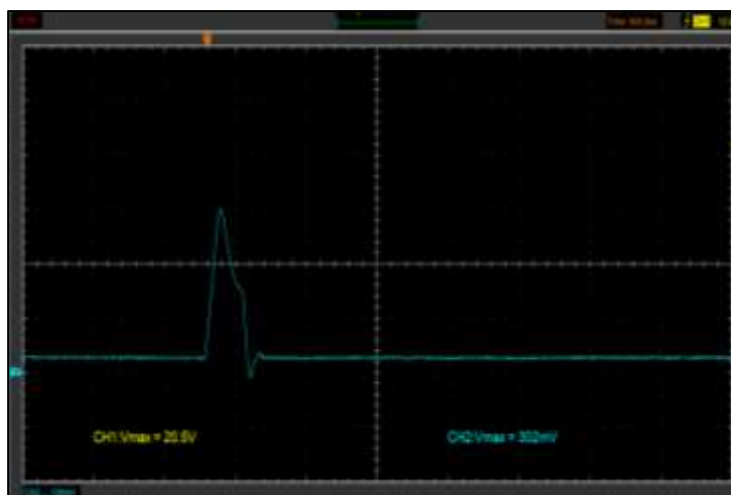
Figura 107 Oscilograma de corriente, tiempo de inyección 0,25ms del inyector CRDI Bosch 0445110126.
