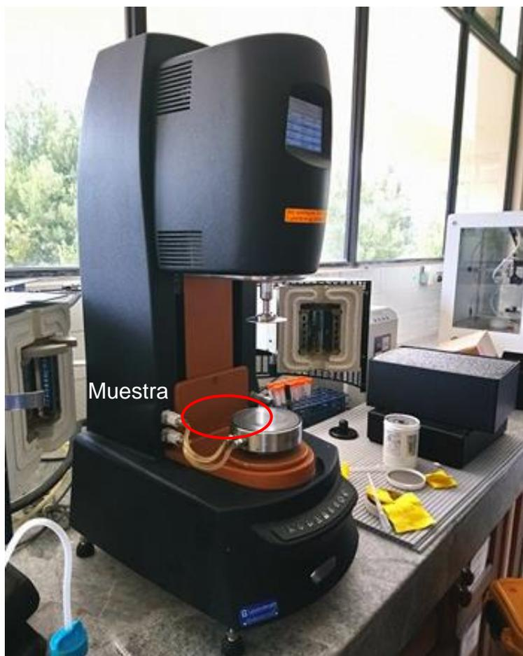
**Figura 43.** Preparación de la muestra en el reómetro previo al estudio reológico
