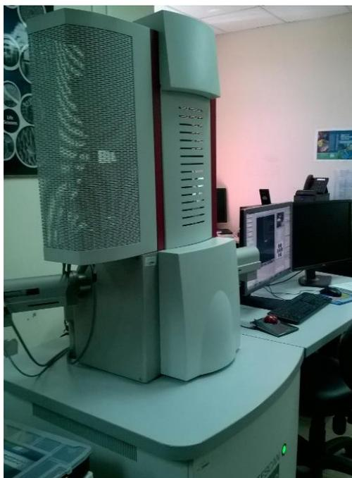
**Figura 26.** Microscopio electrónico de barrido TESCAN
