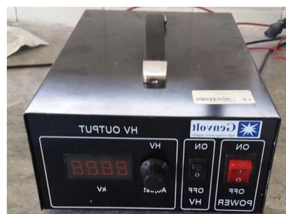
**Figura 34.** Fuente de alto voltaje
