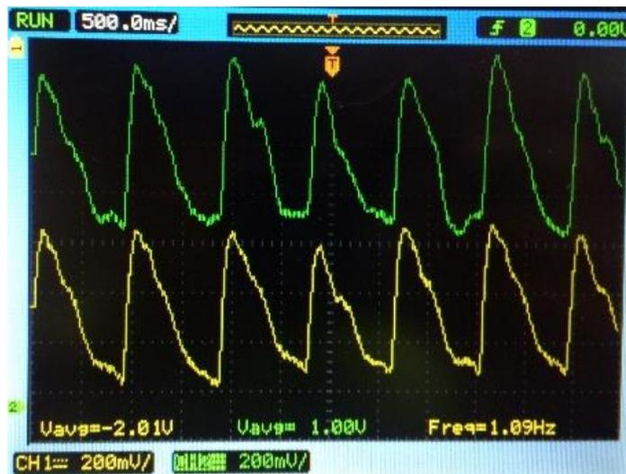
**Figura 31.** Señal PPG utilizando el IC INA128 (Verde) y el IC TL084 (Amarilla).
