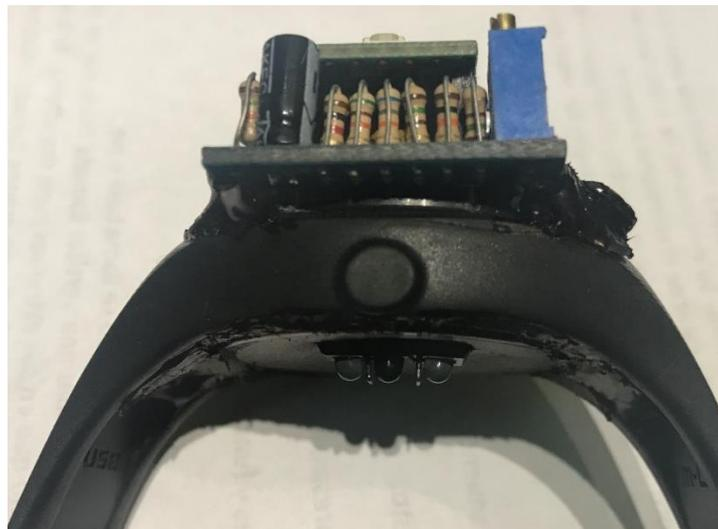
**Figura 40.** Placa PCB adecuada a una correa de reloj.
