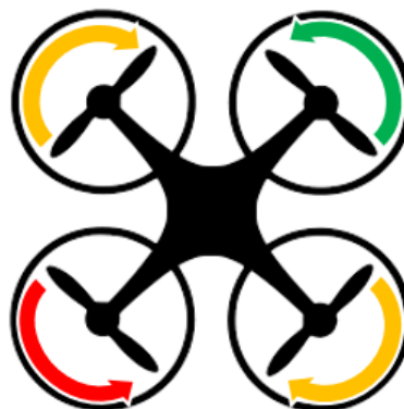
Figura 18 Movimiento Roll. Flechas de color verde muestran aumento de velocidad, flechas de color naranja velocidad promedio y flecha de color rojo representan reducción de velocidad
