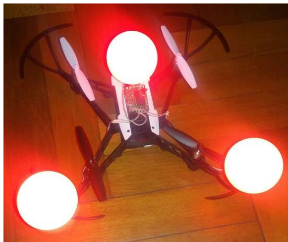
Figura 22 Marcador activo colocado en un vehículo aéreo no tripulado
