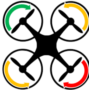
Figura 17 Movimiento Pitch. Flechas de color verde muestran aumento de velocidad, flechas de color naranja velocidad promedio y flecha de color rojo representan reducción de velocidad
