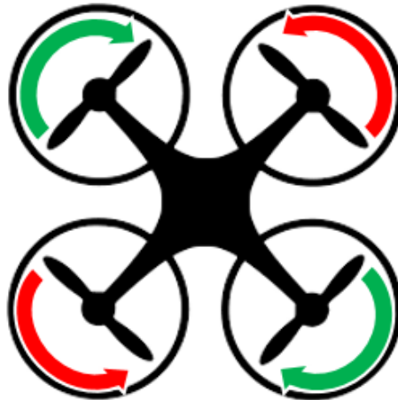
Figura 19 Movimiento Yaw. Flechas de color verde muestran aumento de velocidad y flechas de color rojo representan reducción de velocidad
