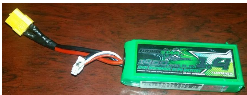
Figura 92 Batería seleccionada Multi Star 1400 mAh
