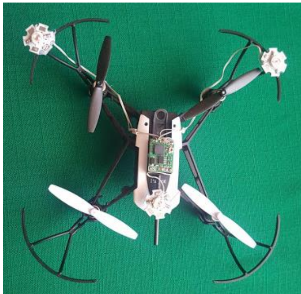
Figura 121 Circuito de alimentación para marcadores activos
