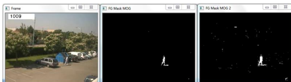
Figura 46 Sustracción de fondo OpenCV Fuente: (Bueno Garcia, y otros, 2015)
