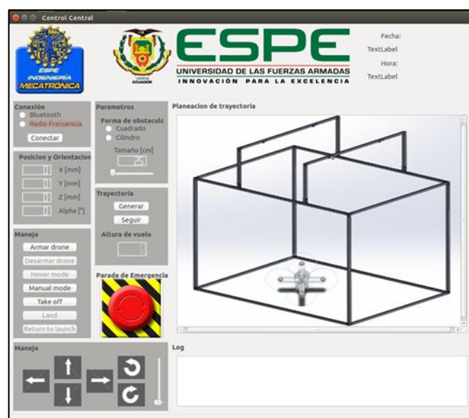
Figura 135 HMI sección portada, monitoreo 1 y control manual
