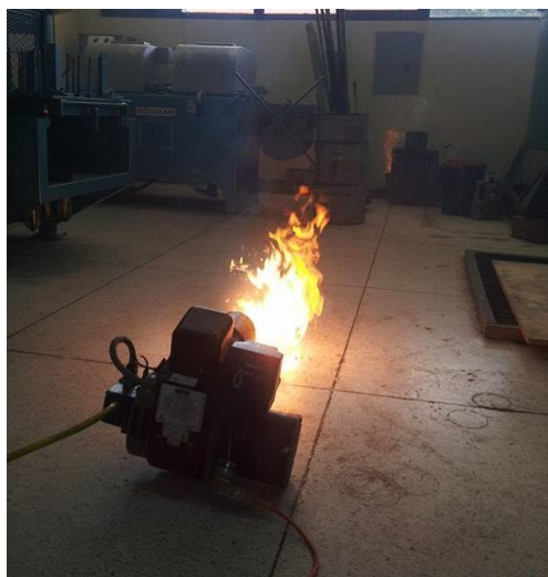
Figura 33. Prueba del quemador
