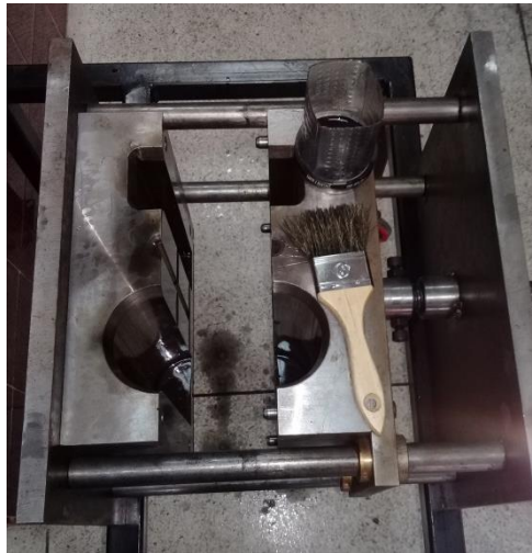
Figura 76. Aplicación de grafito en el molde metálico
