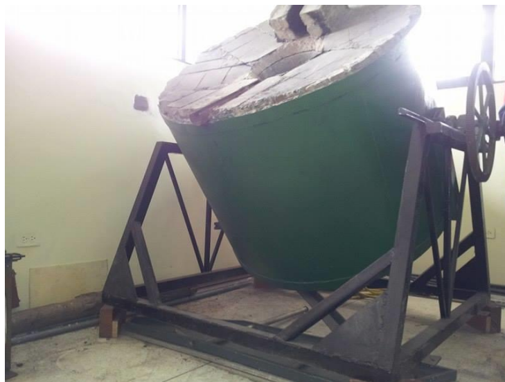
Figura 25. Contacto entre el horno y el soporte transversal
