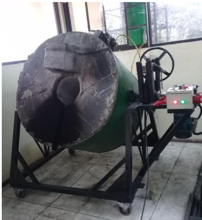
Figura 62. Sistema de basculación automática
