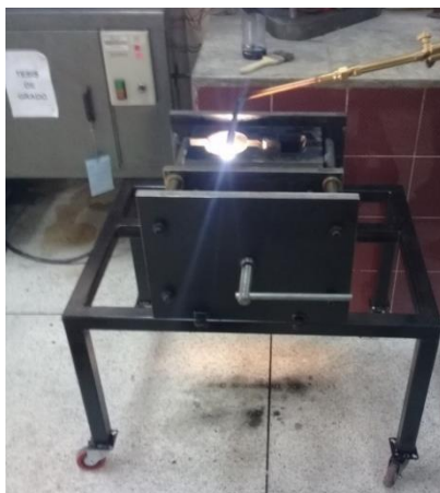
Figura 77. Calentamiento del molde metálico
