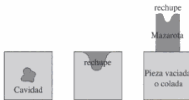
Figura 11. Defectos por contracción
