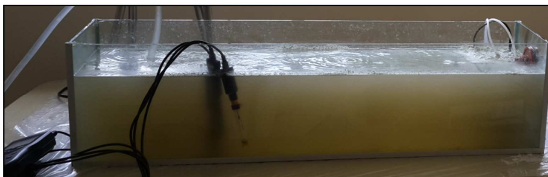
Figura 9 Medición de pH en biorreactor
