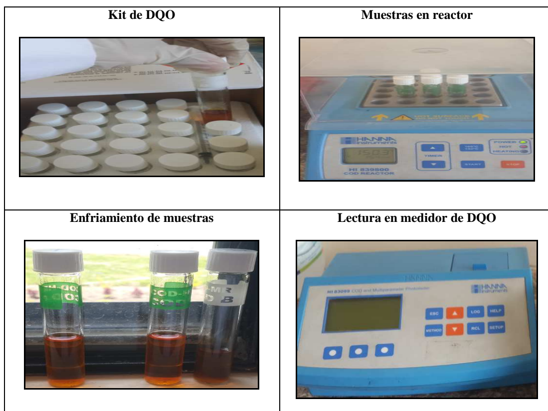
Figura 12 Determinación de DQO en afluente y efluente
