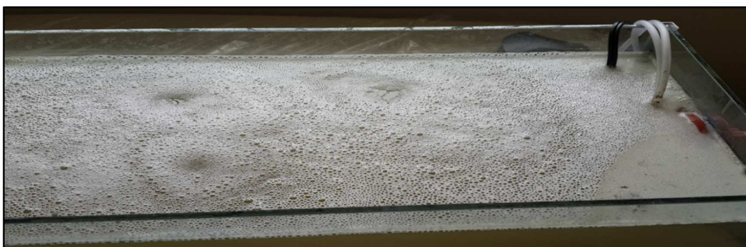
Figura 24 Arranque del Biorreactor formación de espuma Fuente: Mónica G Pérez (2017)
