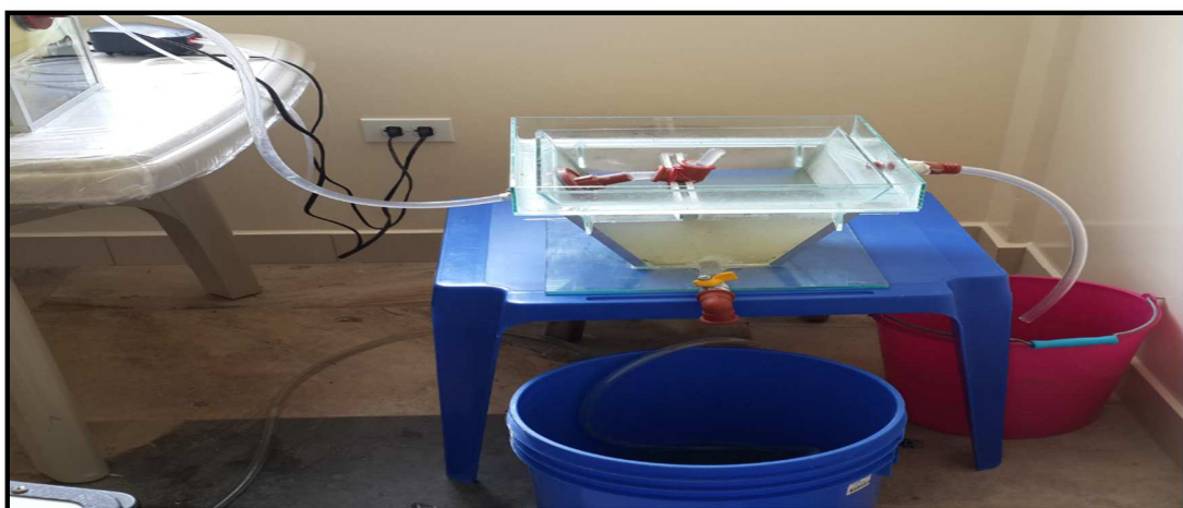
Figura 17 Clarificador Planta Piloto
