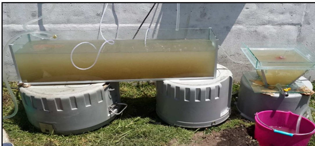
Figura 15 Instalación de Planta Piloto junto al Sedimentador Fuente: Mónica G Pérez (2017)
