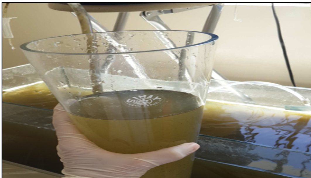
Figura 11 Toma de muestra para sólidos sedimentables Fuente: Mónica G Pérez (2017)
