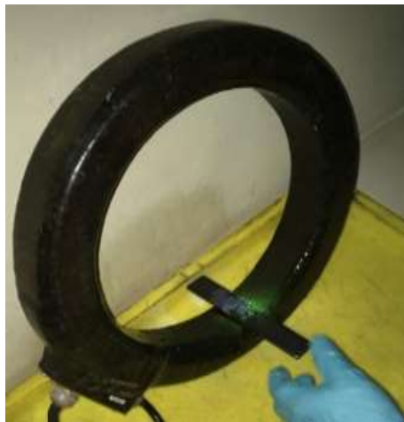
Figura 37 Aplicación de líquido fluorescente en la soldadura
