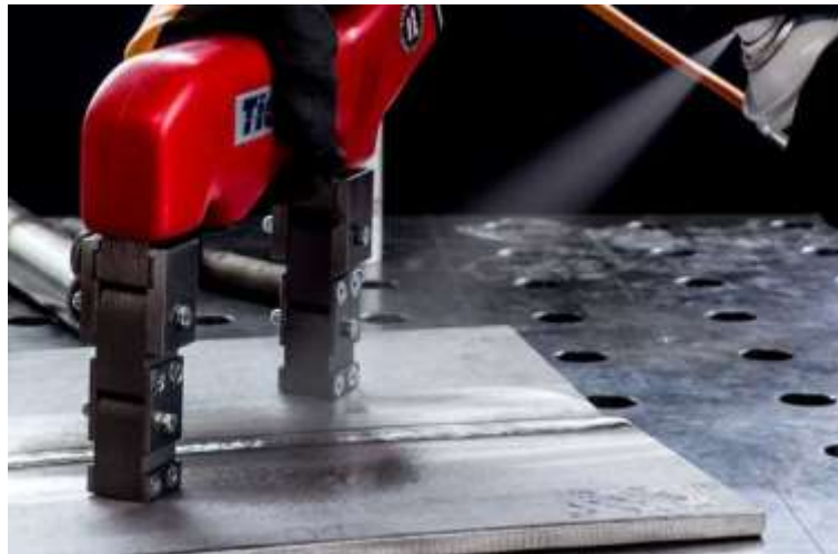
Figura 27 Prueba de partículas magnéticas
