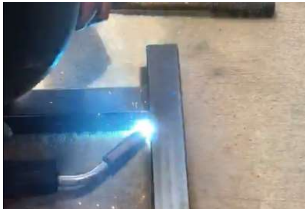
Figura 33 Proceso de suelda de los puntos de unión estructural
