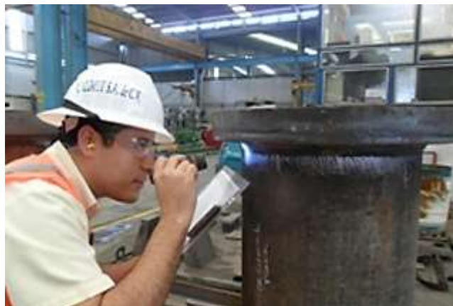
Figura 25 Ensayo no destructivo por inspección visual
