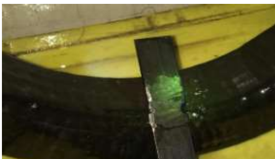
Figura 45 Probeta analizada por Partículas Magnéticas
