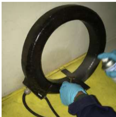
Figura 36 Bobina de ensayo de Partículas Magnéticas
