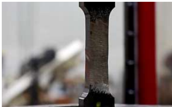
Figura 24 Probeta de prueba a tracción de soldadura
