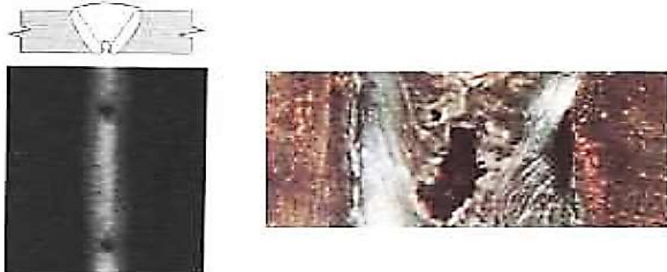
Figura 18 Soldadura con discontinuidad por quemón
