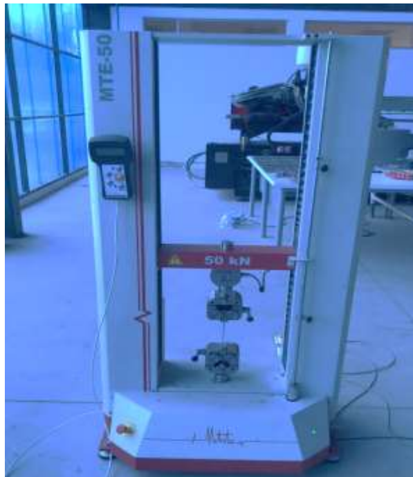
Figura 31 Máquina universal de ensayos MTE 50
