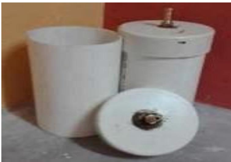
**Figura 40 Reactores de hidrógeno principales de PVC.**
