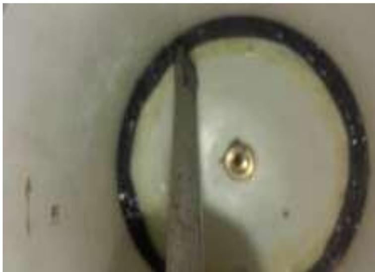
**Figura 41** Pegado de caucho a la tapa de PVC.
