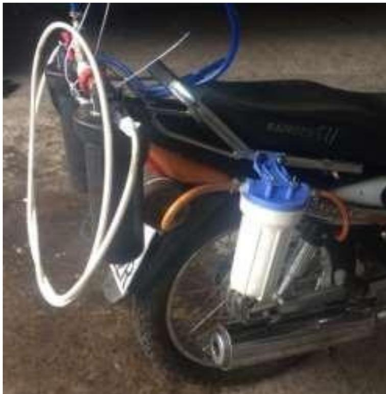
**Figura 58** Fijación del depósito y burbujeador
