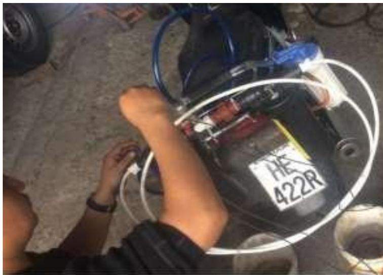
**Figura 57** Fijación del generador del gas HHO
