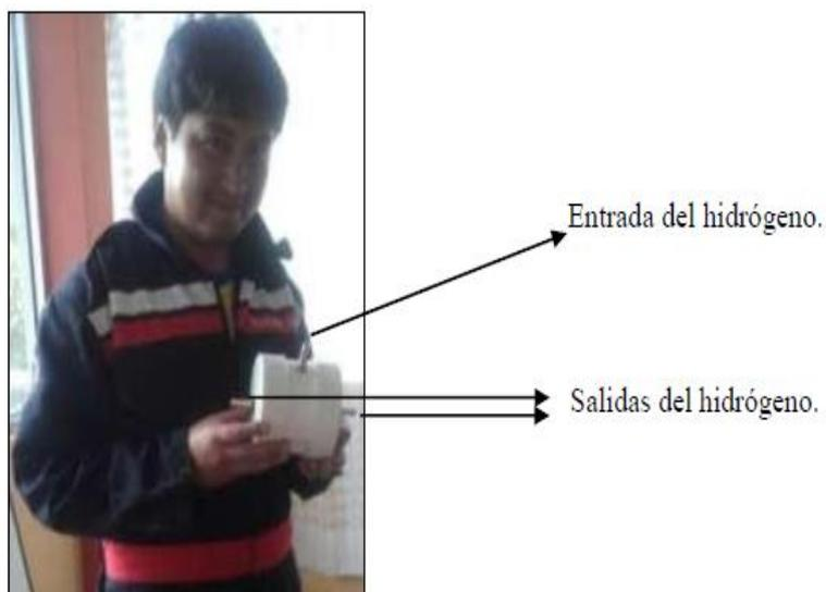
**Figura 44** Mini depósito de hidrógeno de tubo PVC.
