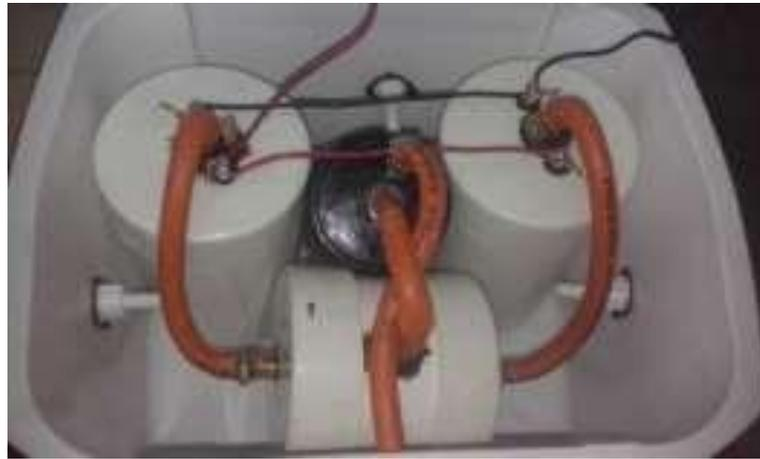
**Figura 55** Instalación del sistema principal a la cuba electrolítica.
