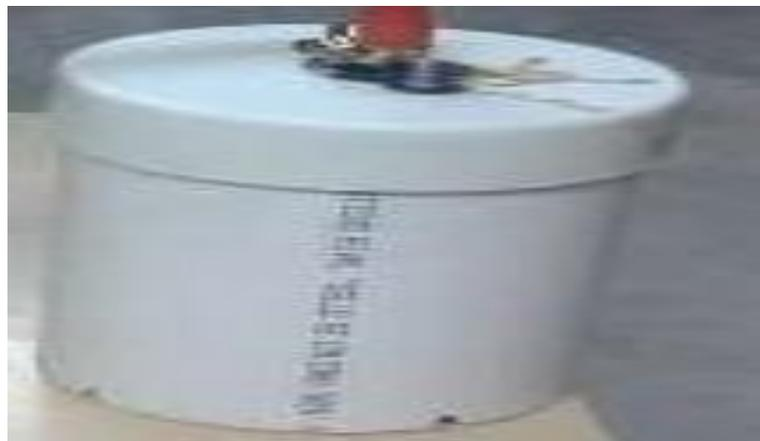
**Figura 48** Acople de la tapa tipo hembra al tubo PVC
