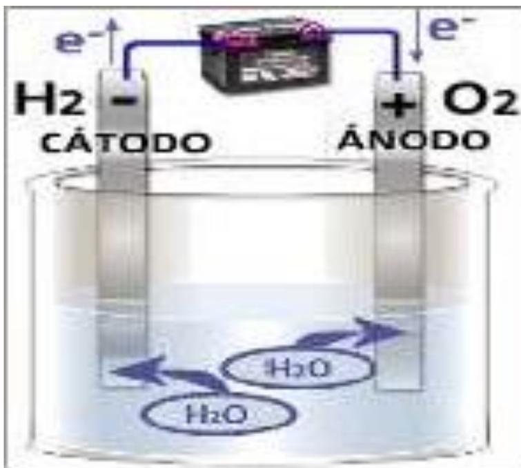
**Figura 21** Diagrama básico de la electrólisis del agua
