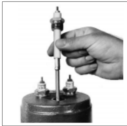
Figura 35: Desmontaje de electrodos del control de nivel.
