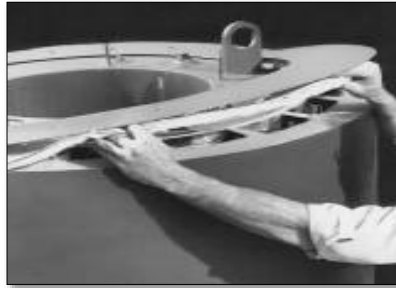
Figura 39. Desmontaje tapa de caldera (Lado de Fuego).
