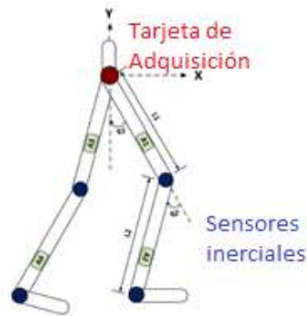
Figura 32. Modelo del prototipo de adquisición de patrones de marcha
