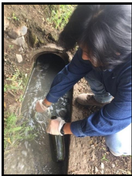
Figura 13 Toma de muestra del efluente de la PTAR
