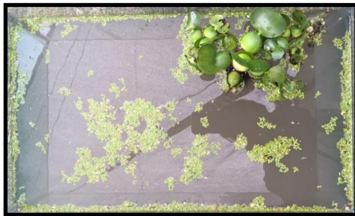
Figura 18 Reactor con Lemna minor y Eichhornia crassipes
