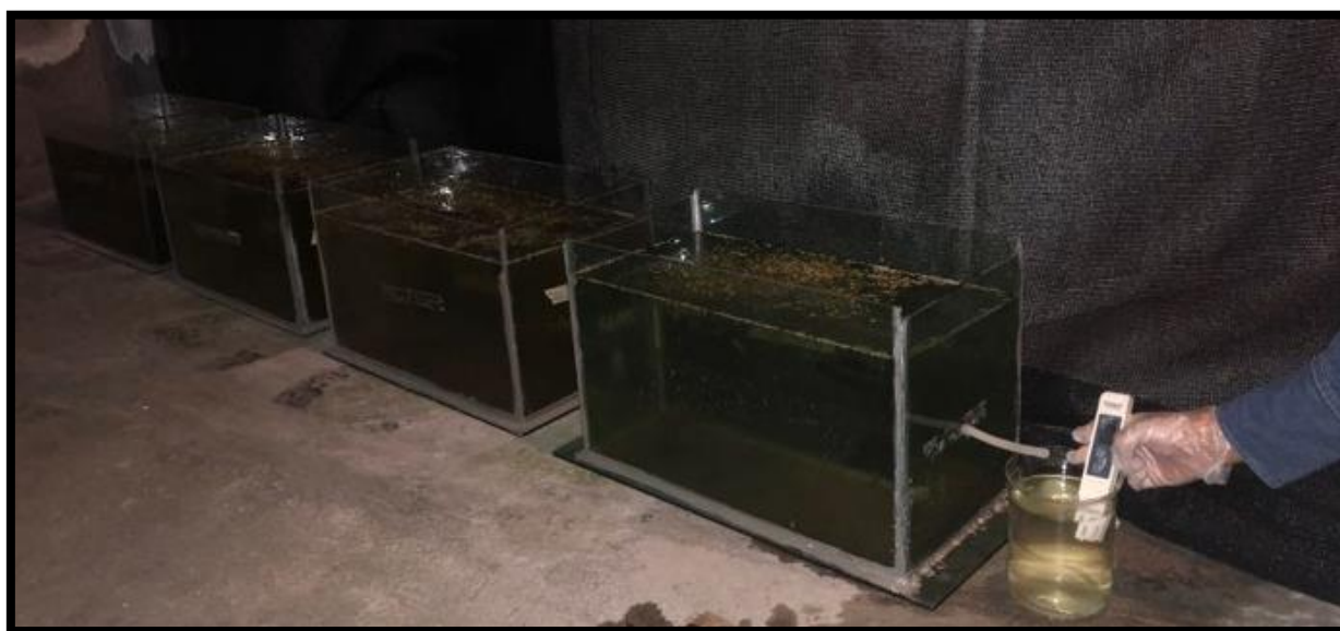
Figura 36 Esquema de reactores con Lenteja de agua, en el análisis con sensores ambientales
