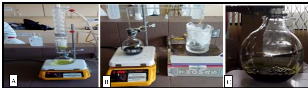
Figura 12 Determinación del porcentaje de grasas mediante el método Soxhlet (A) Destilación;(B) Extracción del solvente; (C) obtención del porcentaje de grasa
