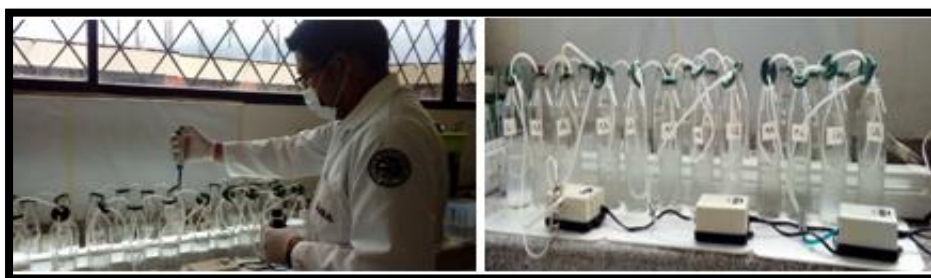
Figura 18 Instalación del ensayo; pesticidas-biomasa de microalga
