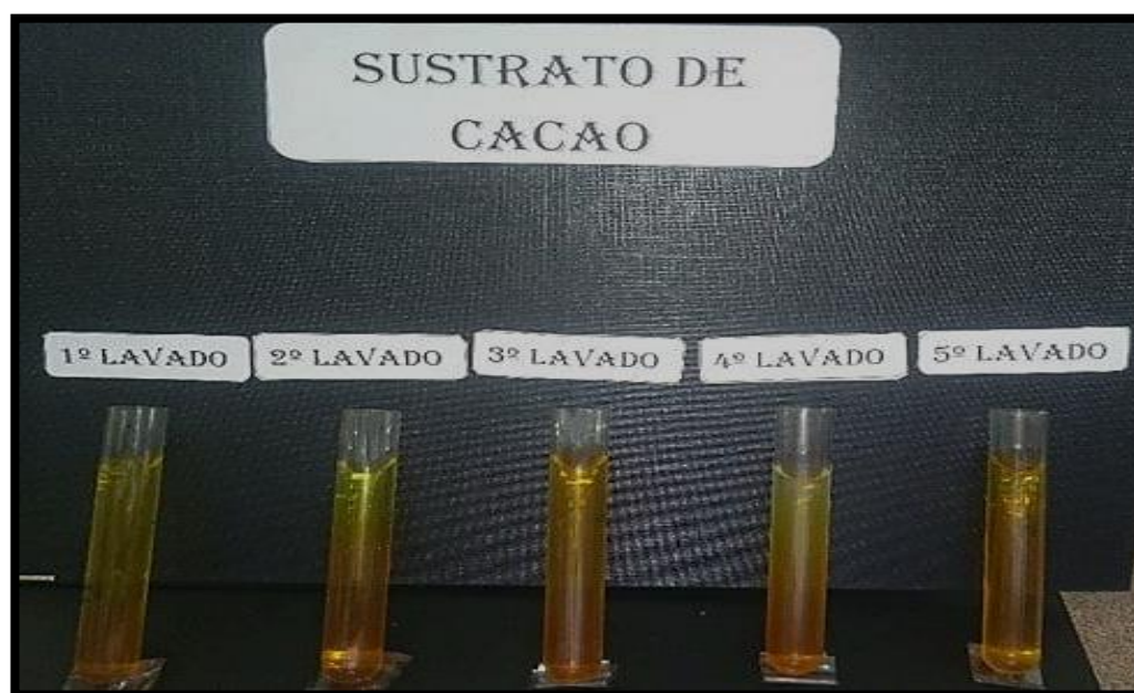
Figura 11 Prueba bioquímica de Wagner para la detección de alcaloides en el sustrato de cacao después de cinco lavados
