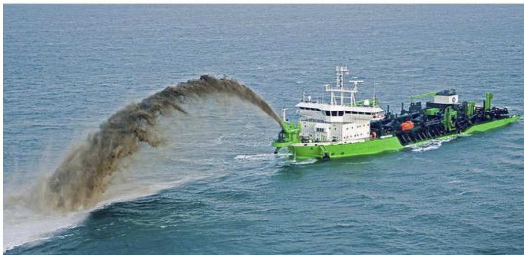
Figura. 8 Draga de succión simple
