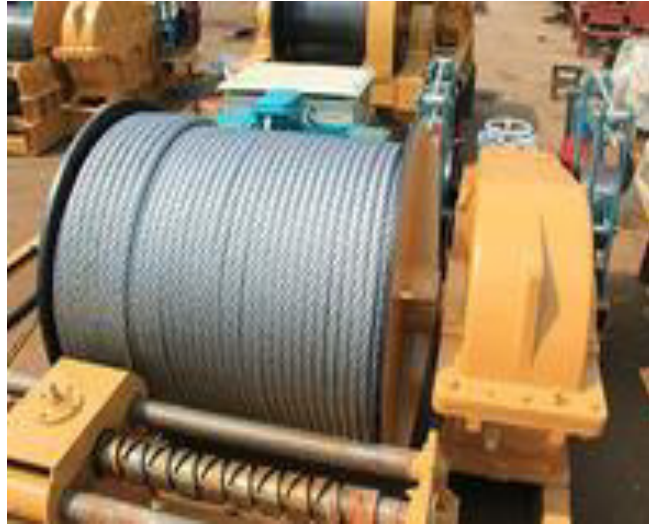
Figura 5.3 Electric Hand Winch With Failsafe Brake Fuente y elaborado por: Astilleros Asenabra S.A.
