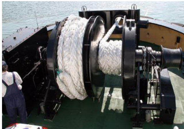
Figura 3.6 Chigre de remolcador motor eléctrico tambor simple Fuente: Remolcadores Elaborado por: Ingeniero Marino
