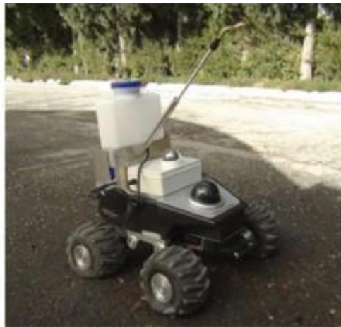
Figura 3. Robot móvil Summit XL de Robotnik Fuente: (Adamides, 2013)
