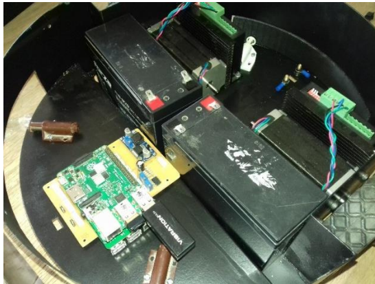
Figura 96. Montaje de placa electrónica, baterías y drivers.
