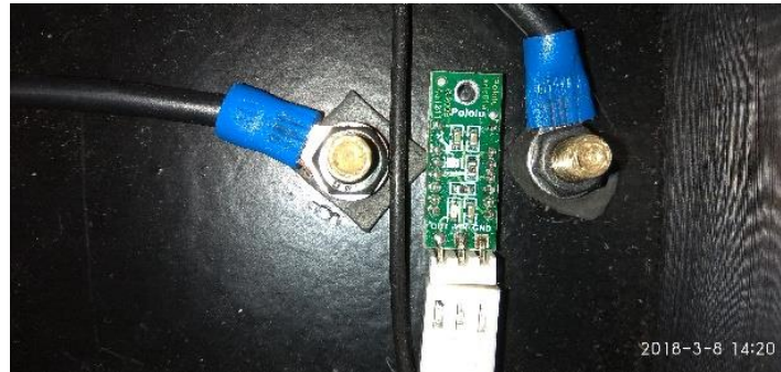
Figura 97. Montaje de pines de carga en el robot móvil y sensor Sharp.
