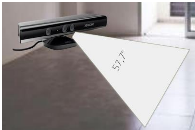
Figura 33. Campo de visión frontal horizontal del sensor Kinect.
