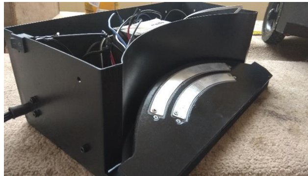
Figura 103. Estructura ensamblada de la estación de carga.
