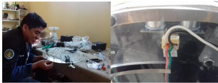
Figura 99. Montaje de sensores ultrasónicos en la base del módulo.
