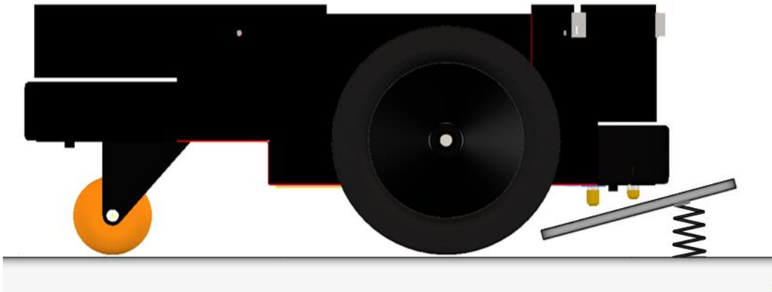
Figura 72. Sistema de Pedal para acople de la plataforma móvil y estación de carga.
