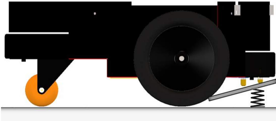
Figura 73. Sistema de acople del robot y la estación de carga .
