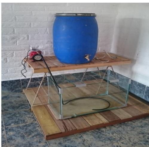
**Figura 6** Implementación del Sistema de Tratamiento de Lodos Activados
