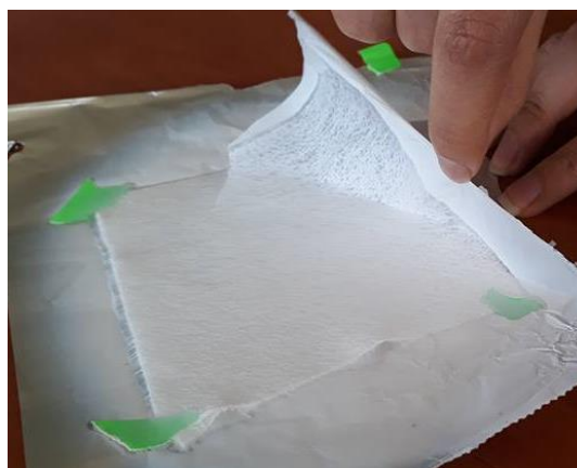
Figura 35. Membrana correspondiente a una solución de CS 2% w/v en AA 70% v/v + PVA 10% w/v
