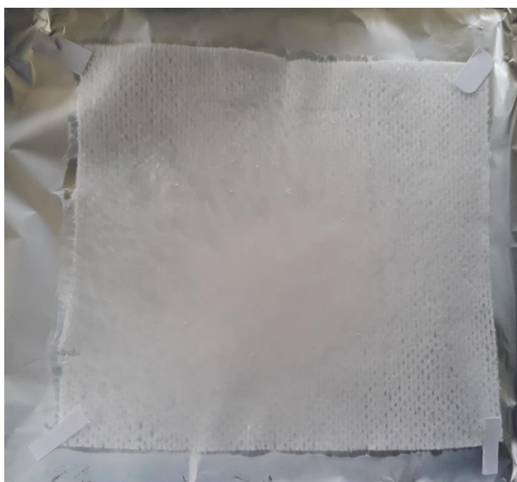
Figura 50. Membrana recolectada de solución de (CS 2% w/v en AA 70% v/v + PVA 10% w/v) + SD 40% v/v (3:1)
