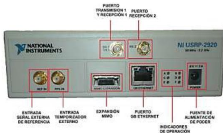
Figura 18. Panel frontal del USRP-2920 Fuente: (Balseca & Jurado, 2014)
