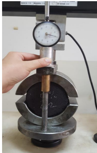
Figura 21. Colocación del deformímetro en la varilla guía
