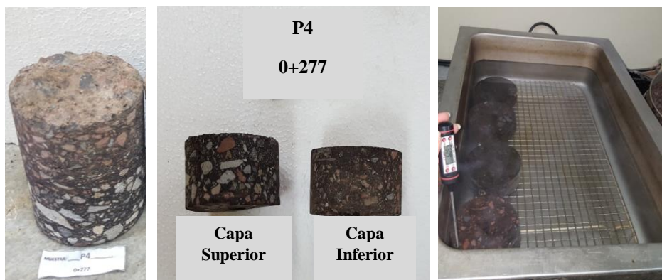
Figura 105. Procedimiento ensayo Estabilidad y flujo a los testigos P 4 y P 9
