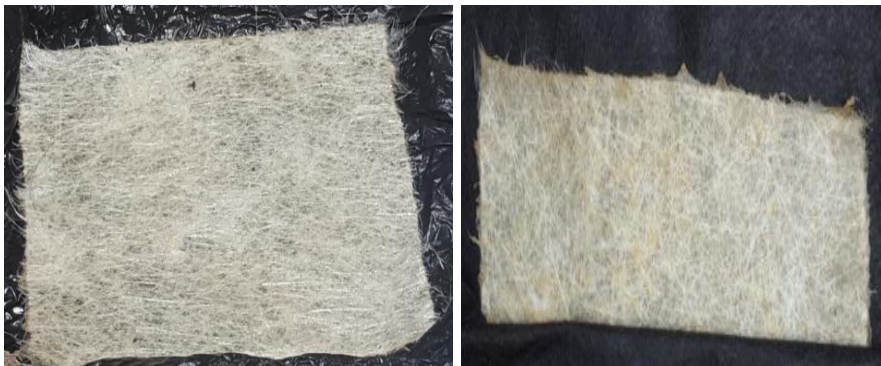
Figura 73. a) Proceso de secado del refuerzo, b) Resultado final
