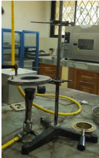
Figura 16. Aparato copa abierta de Cleveland
