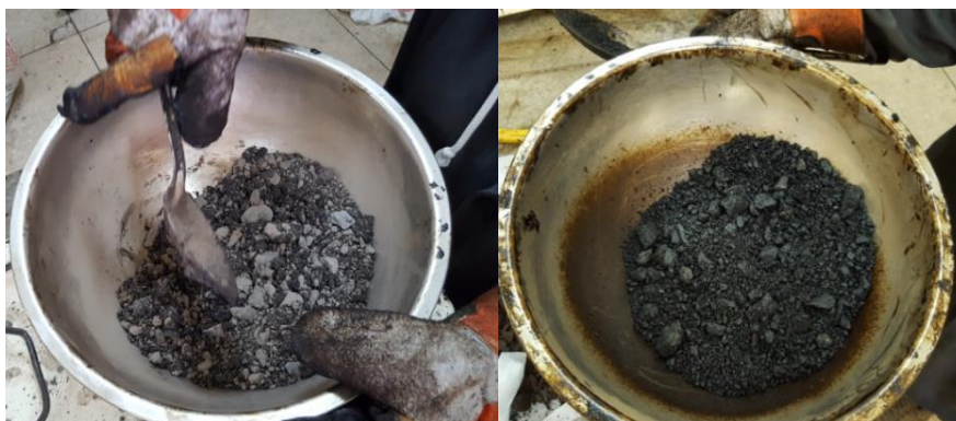
Figura 41. Elaboración de la mezcla asfáltica
