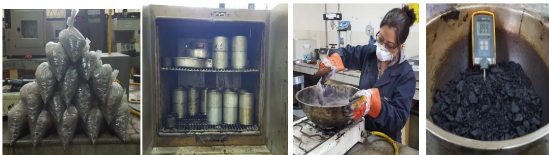
Figura 53. Preparación de la mezcla asfáltica
