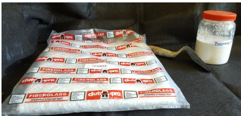
Figura 71. Materiales para la fabricación del refuerzo de fibra de vidrio con isopreno
