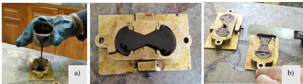
Figura 48. a) Colocación del asfalto en el molde, b) preparación de probeta para el ensayo
