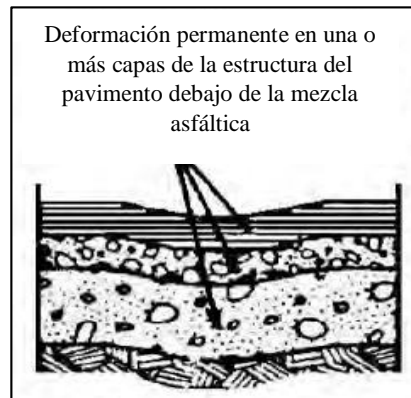
Figura 5. Deformación debida al fallo de la Subrasante Fuente: (Morea, 2011)
