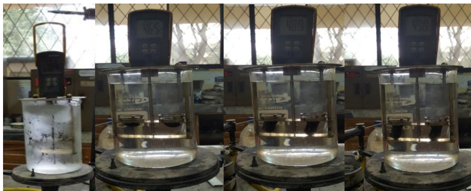
Figura 46. Procedimiento de ensayo punto de ablandamiento
