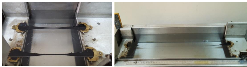
Figura 49. Ensayo de ductilidad en proceso
