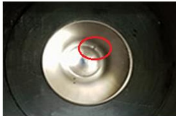
Figura 41. Aparición de grieta en el borde del agujero
