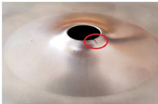
Figura 44. Ruptura de la placa en el borde del agujero perforado
