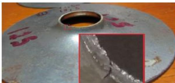
Figura 12. Prueba de expansión de agujero valida; ruptura a través del espesor de la placa Fuente: (Thesing , Boff , & Schaeffer , 2016)
