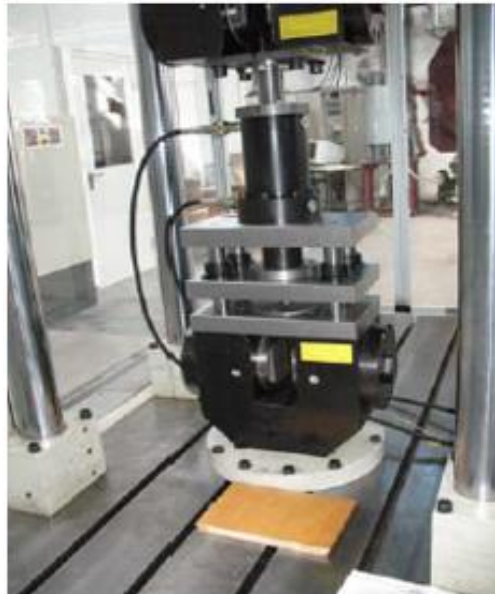
Figura 11. Dispositivo de Hole Expansion instrumentado montado en la máquina de pruebas de tracción universal tipo W+B 600
