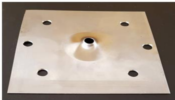
Figura 42. Agujero de 4 mm expandido con punzón cónico
