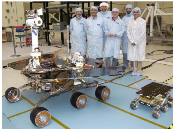
Figura 12. MER (izquierda) con Sojourner de la misión Mars Pathfinder de 1997 (derecha).
