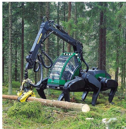
Figura 3. Robot Hexapod, máquina taladora hecha por Plustech
