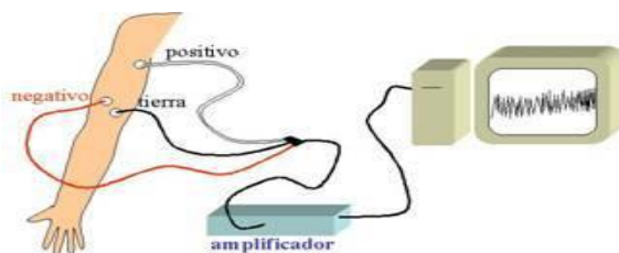
Figura 16. Señales mioeléctricas generadas al contraer los músculos Fuente: (Ramiro, Vergara, & Vázquez, 2011)
