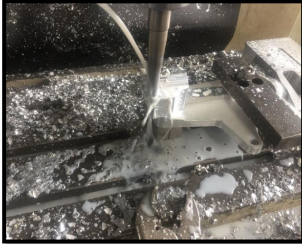
Figura 71. Acabado de soportes de suspensión
