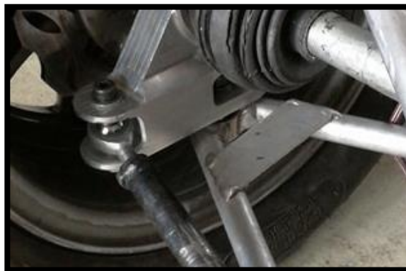
Figura 76. Anclaje de soportes inferiores de suspensión
