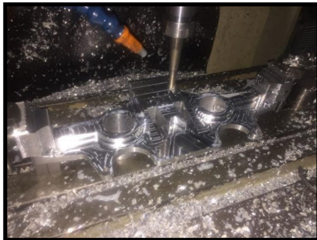
Figura 70. Desbaste Segunda cara
