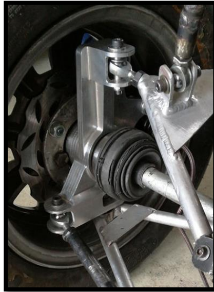
Figura 77. Acople general de soportes de mangueta posterior
