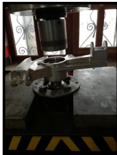
Figura 78. Instalación de la manzana en la mangueta
