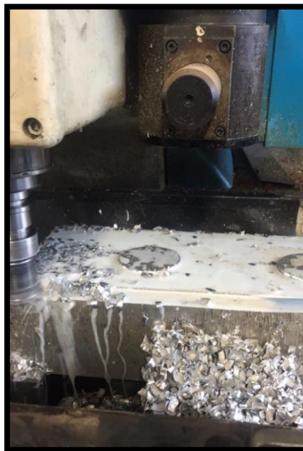
Figura 68. Desbaste del bloque de aluminio
