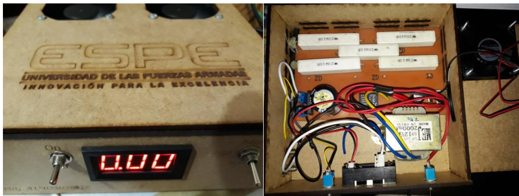
Figura 35. Módulo de carga para baterías HV de 150 voltios
