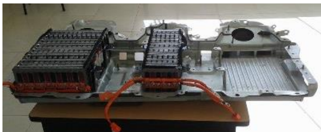
Figura 18. Batería HV Toyota Highlander
