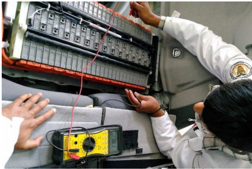
Figura 13. Comprobación del estado de la batería y medición de voltaje
