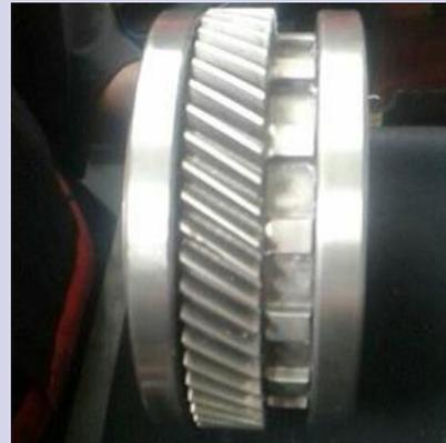
El engrane de la cara exterior de la corona tiene 54 dientes, el cual se conecta con el engrane 1 de 55 dientes.
