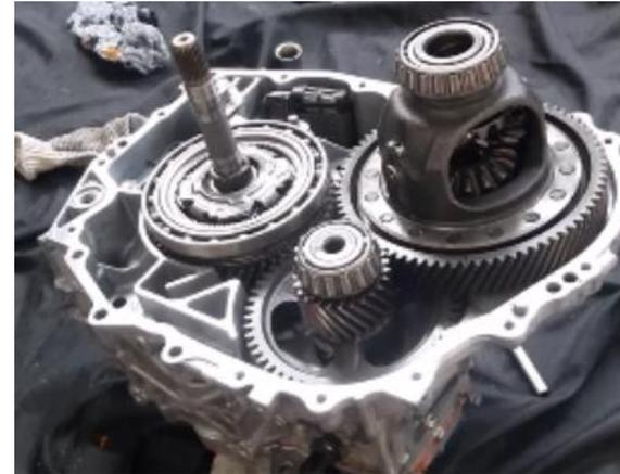
Ensamblar el sensor resolver del moto generador 1 en su carcasa para unir la carcasa del moto generador 1 con la del moto generador 2.
