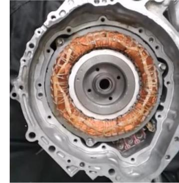
Sacar los pernos que sujetan las fases U, V y W del moto generador 1.
