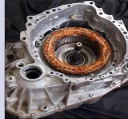
Colocar el imán permanente y apretar los pernos de las fases U, V y W del moto generador 2.
