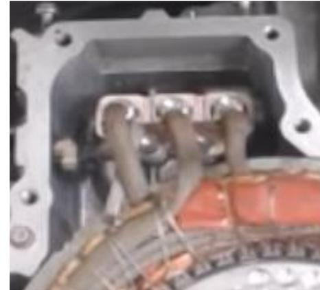
Se proceder a sacar los pernos que sujetan a la bobina y al imán permanente a la carcasa de aluminio.
