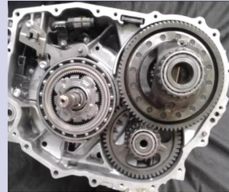
Al separar los dos moto generadores se procede a sacar la tapa externa del moto generador 2, a la vez también sacar los pernos del sensor resolver del moto generador 2.
