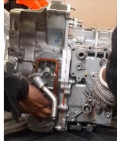
Instalar la bomba de aceite y el sensor de posición ubicados a los lados del motor ensamblado completo
