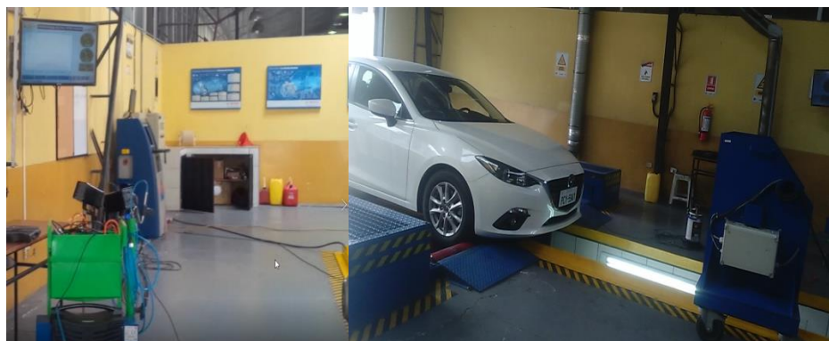
Figura 34. Equipos del dinamómetro MAHA LPS 300
