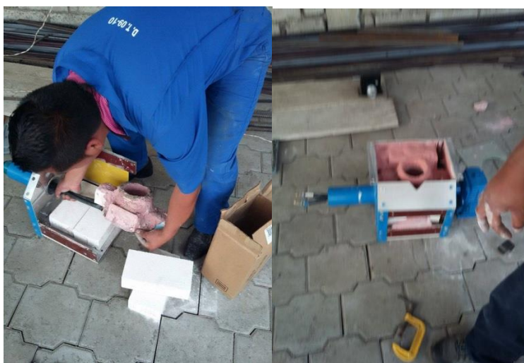
Figura 34. Acople de bobina de inducción en la caja.
