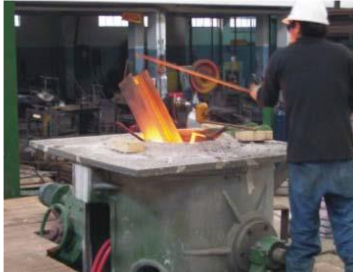
Figura 2. Horno de inducción sin núcleo magnético.
