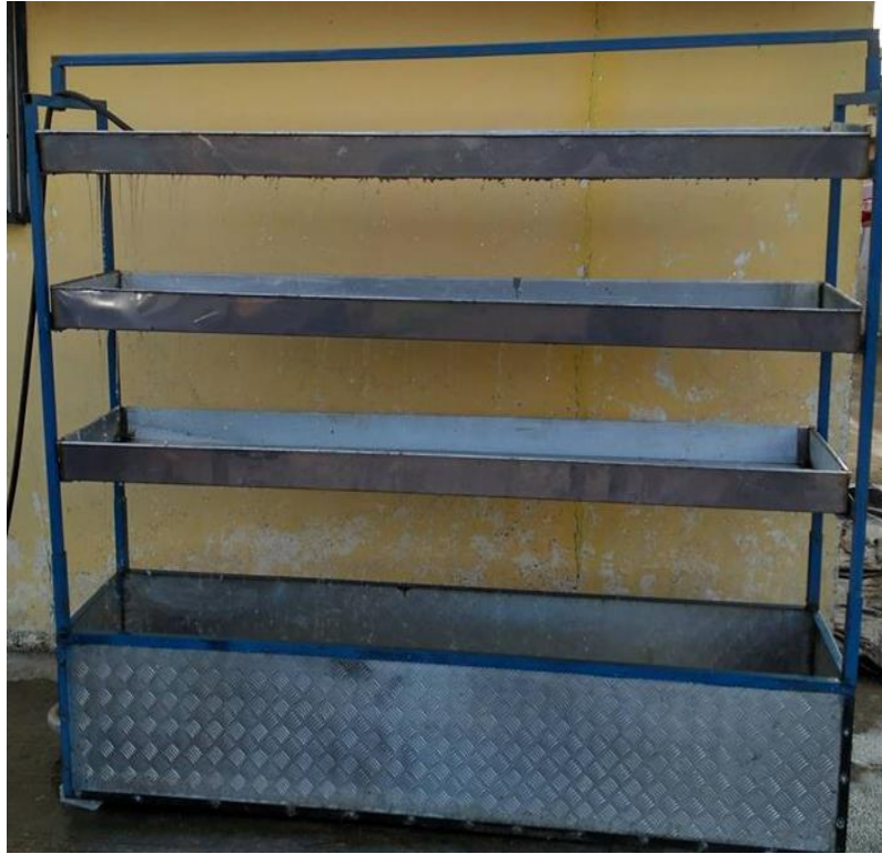
Figura 40. Torre de refrigeración de tiro natural.
