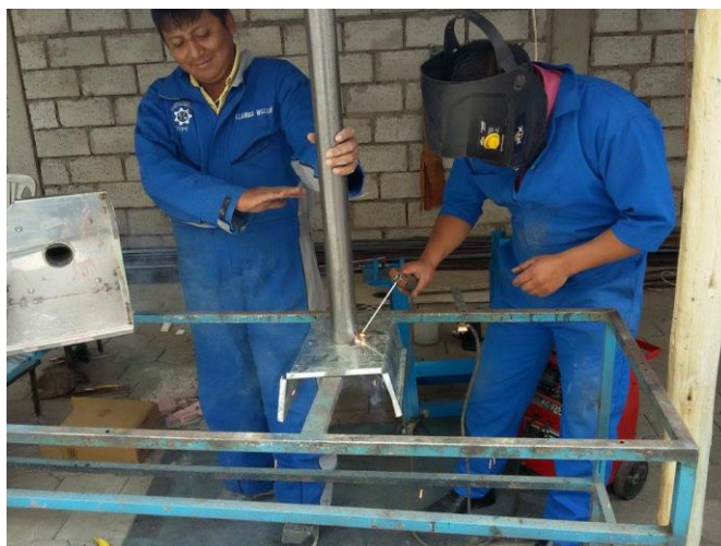
Figura 33. Construcción de la caja para la bobina inductora.
