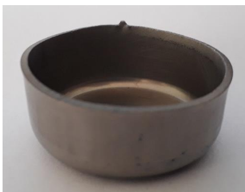
Figura 83 Copa embutida Lubricación Blanco – Matriz: Lubricante Grasa multipropósito.
