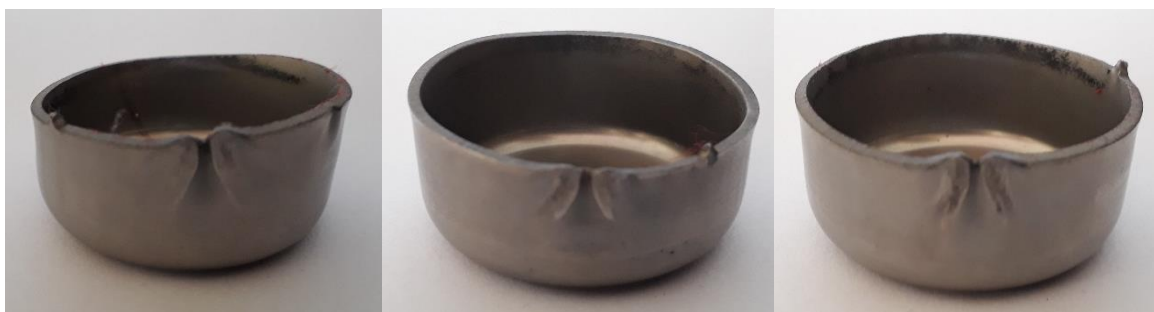
Figura 82 Copa embutida Lubricación Punzón – Blanco. De izq a der: Lubricante aceite vegetal, Lubricante aceite mineral, grasa multipropósito.
