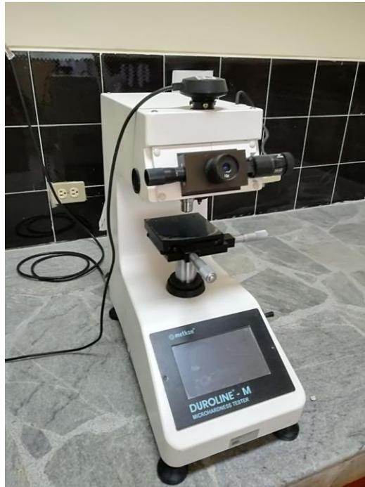
**Figura 36** Microdurómetro digital marca Metkon modelo Duoline M.
