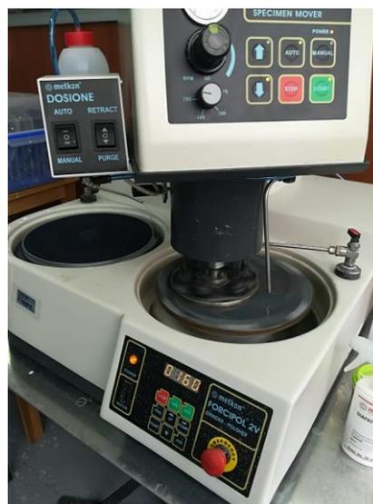
**Figura 26:** Pulidora automática marca METKON.
