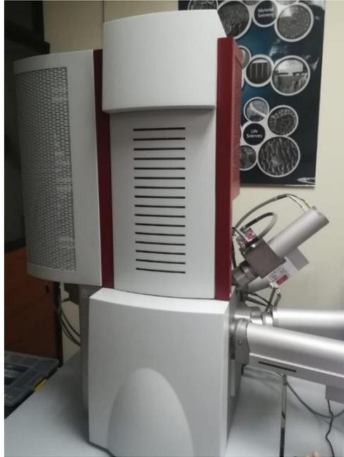
**Figura 33** Microscopio electrónico de barrido TESCAN MIRA 3 FG
