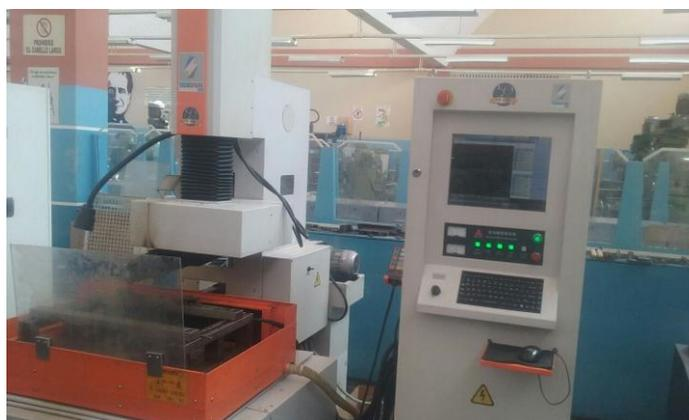
**Figura 24** Máquina de corte con electro hilo.
