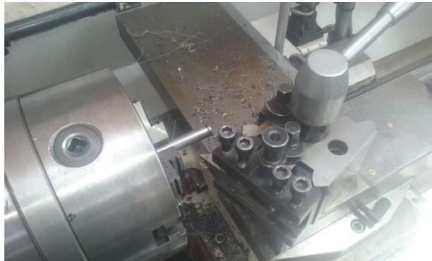
**Figura 23** Preparación de probeta de aleación  $Ti_6Al_4V$ .
