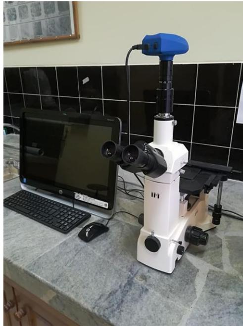
*Figura 32* Microscopio metalográfico MEIJI TECHNO IM7000.
