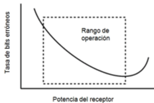
Figura 8 Relación tasa de bits erróneos y potencia Fuente: (The Fiber Optic Association, 2018)
