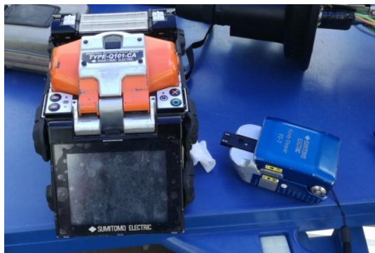
Figura 72 Empalmadora y cortadora de fibra
