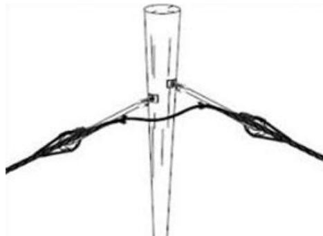
Figura 49 Instalación en Herraje tipo A mediante preformados. Fuente: (Jahentelecom, 2018)
