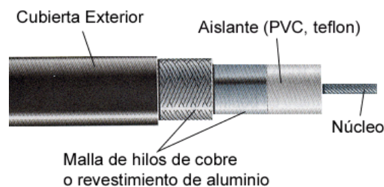
Figura 1.14. Composición de un Cable Coaxial.
