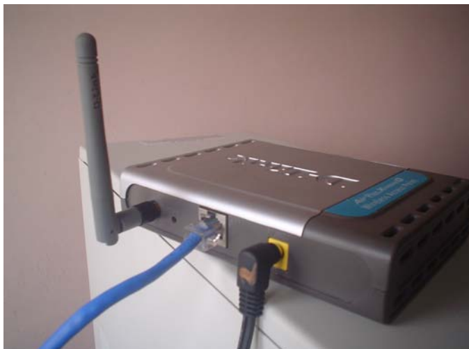
Figura 4.13. Conexión del punto de acceso inalámbrico DWL-2100AP .
