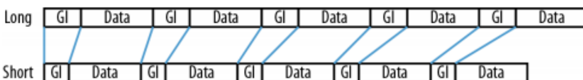
Figura 27. Comparación entre un intervalo de guarda largo y un intervalo de guarda corto Fuente: (Gast, 802.11n: A Survival Guide, 2012)
