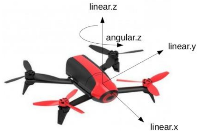
Figura 30. Esquema de desplazamiento positivos del UAV
