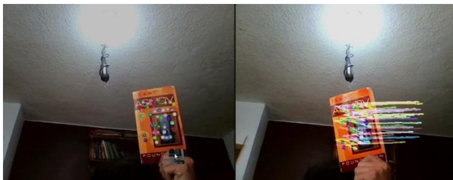
Figura 38. Seguimiento de los puntos de interés de un objeto desplazado
