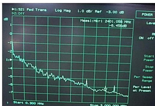
Figura 70. Medición de Pérdidas en el Cable de Transmisión.
