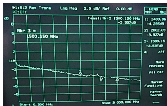
Figura 71. Medición de Pérdidas en el Cable de Recepción.
