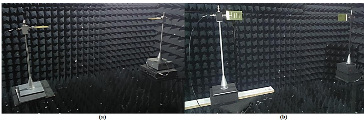
Figura 77. Antena Yagui-Uda polarización Horizontal (a) y Vertical (b)
