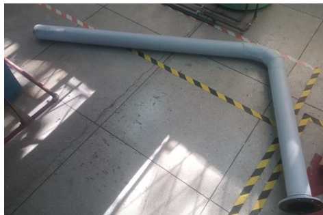
Figura 31 Pintura del ducto.
