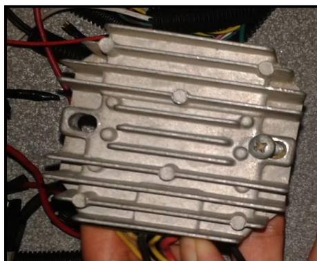
Figura No. 59. Regulador de voltaje
