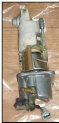
Figura 51. Bomba de combustible
