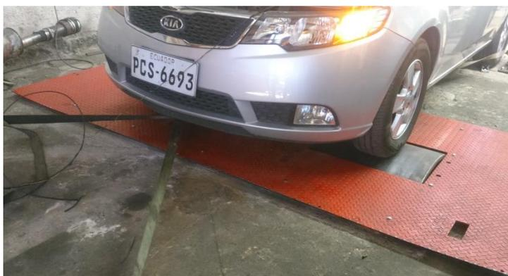
**Figura 15.** Dinamómetro 3000-Lite 2WD IO Chassis Dyno
