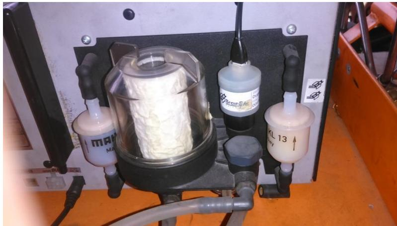
**Figura 14.** Filtros del analizador de gases
