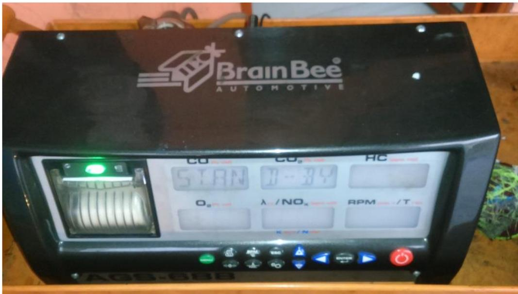
**Figura 13.** Pantallas del analizador de gases
