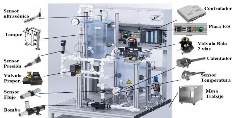
**Figura 20** Componentes de estación ETC
