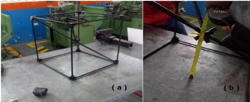
a) Unión con pegamento de las barras b) Verificación de nivel de las caras c) Inspección del nivel en todos los vértices
