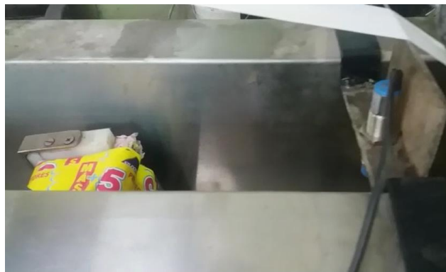
Figura 85. Pruebas de sensor de presencia
