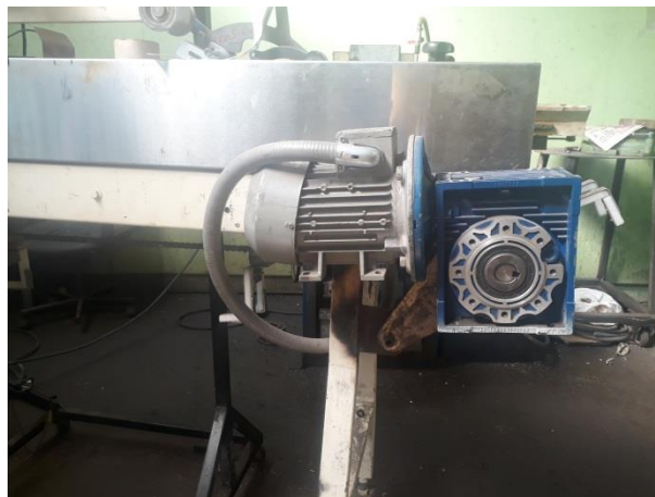
Figura 69. Montaje de la caja reductora
