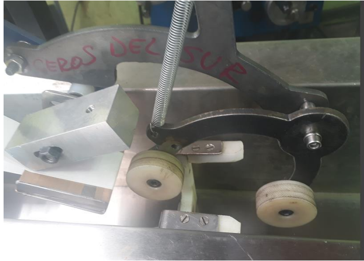
Figura 71. Montaje del aplicador de etiqueta
