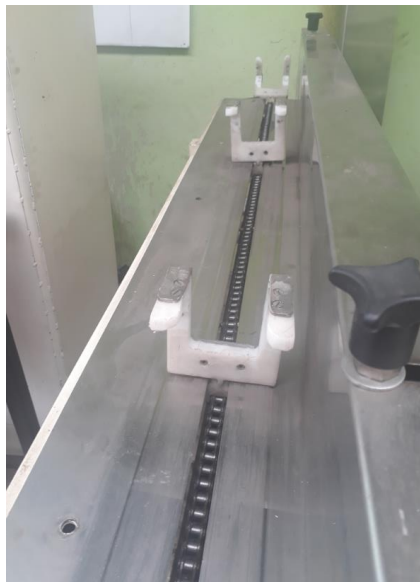
Figura 68. Montaje de la cadena
