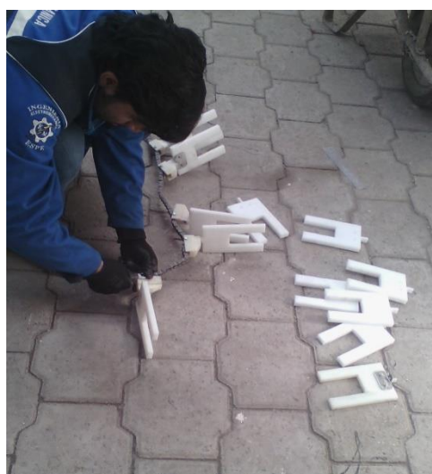
Figura 65. Montaje de las paletas a la cadena
