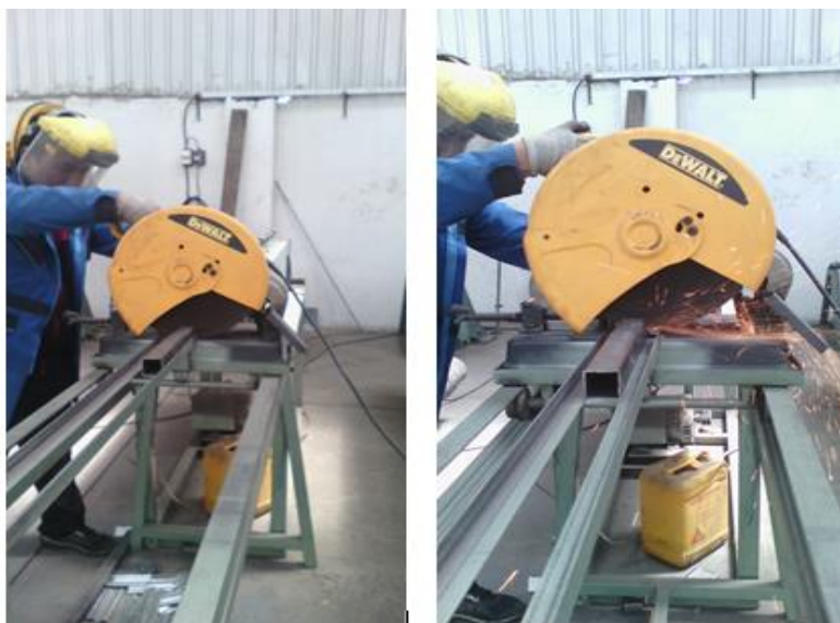
Figura 62. Construcción de la Base de soporte
