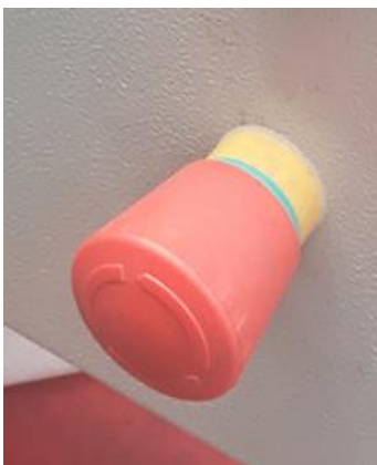
Figura 81. Paro de Emergencia
