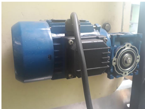
Figura 70. Montaje de la caja reductora
