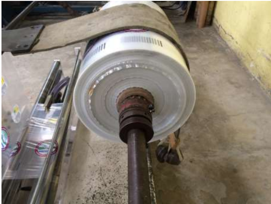
Figura 25. Sujeción del rollo con pesas
