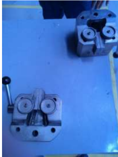
Figura 22. Mordazas para probetas plásticas
