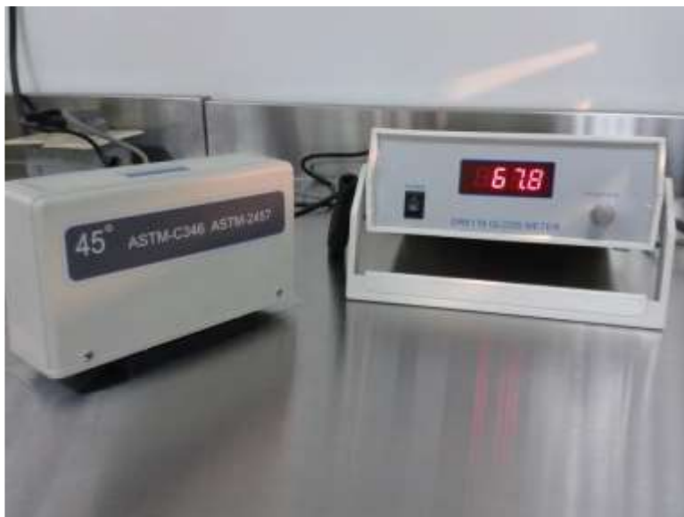
Figura 20. Equipo de medición de brillo
