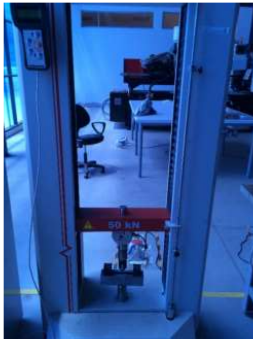
Figura 23. Máquina de Tracción
