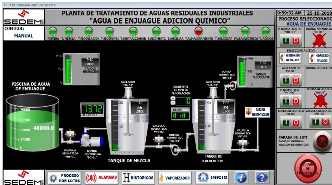
Figura 152. Pantalla Adición de Químicos de ADE.
