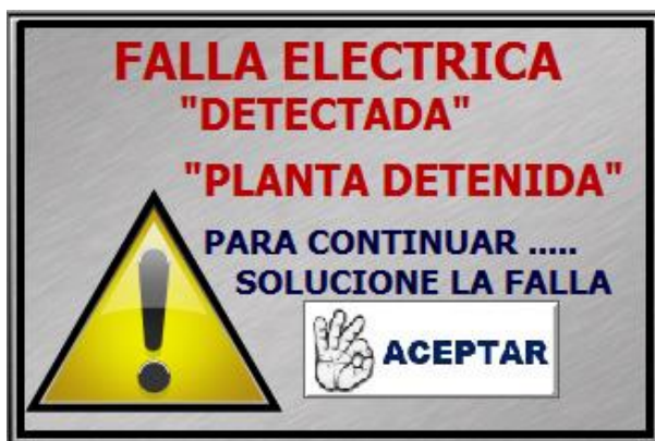
Figura 179. Etiqueta de Alarma de Falla Eléctrica.
