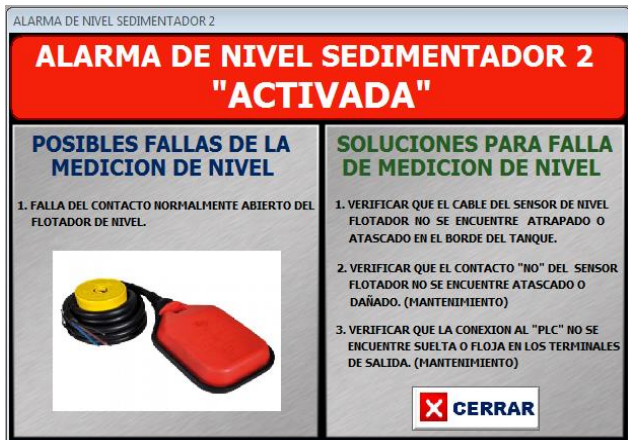
Figura 166. Aviso de riesgo de derrame del “Tanque Sedimentador 2
