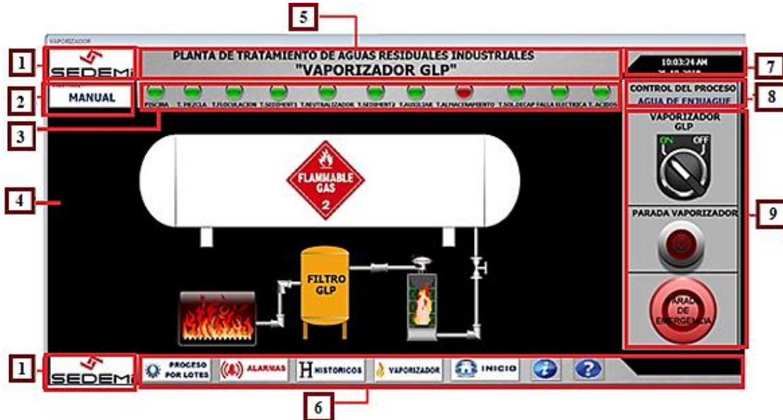
Figura 128. Pantalla de Control Manual Vaporizador.
