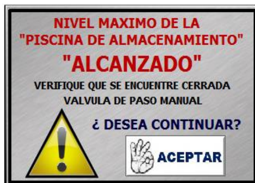
Figura 153. Aviso de nivel Máximo “Piscina de Almacenamiento”.
