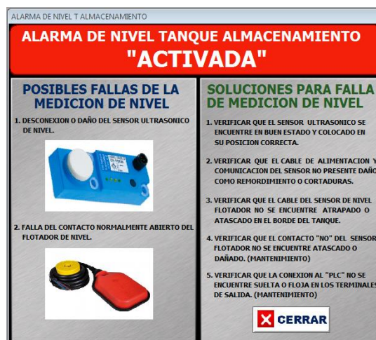
Figura 171. Aviso de riesgo de derrame del “Tanque de Almacenamiento”.
