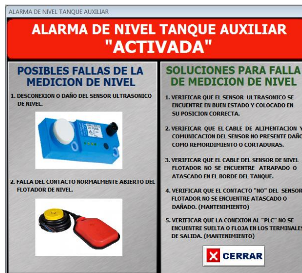
Figura 169. Aviso de riesgo de derrame del “Tanque Auxiliar”.
